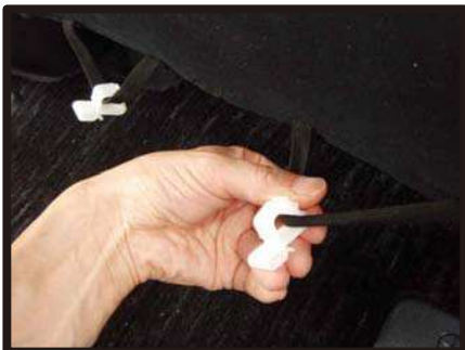
②純正カバーは座面下に図のようなプラスチックの部品で固定されています。これを、車体前側に向かってずらすと外れます。
