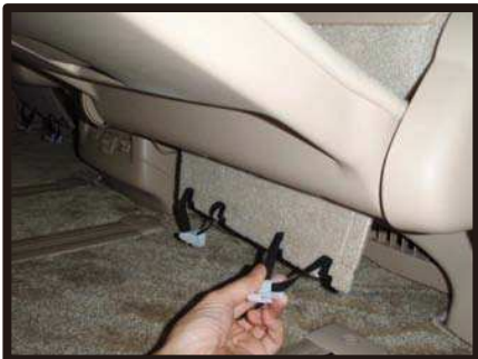
①座面カバーを取り付ける前に背もたれ裏側下の純正カバーを外します。
