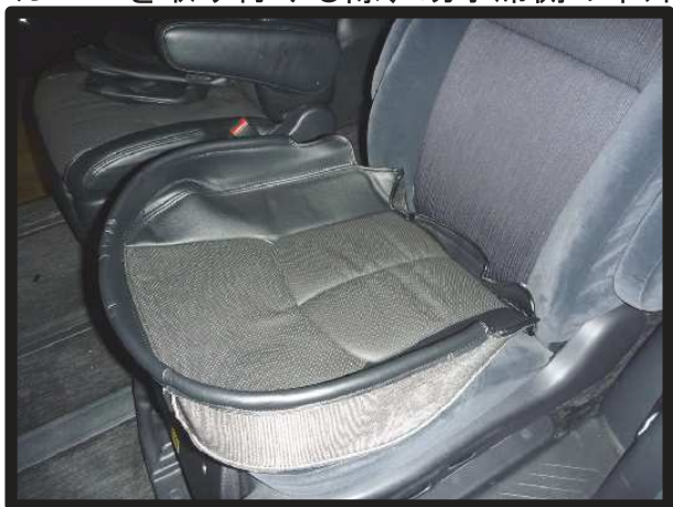
①座面カバーの側面を折り返し、座面とカバーのラインを合わせます。
