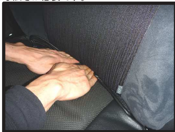
④座面と背もたれの上にシートカバーを入れ込みます。
