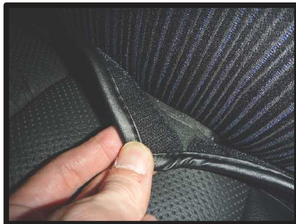
⑤マジックテープでシートに直接固定します。
