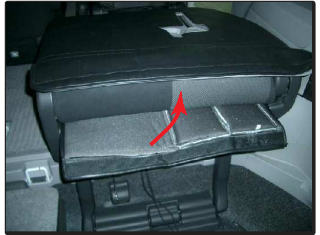
④座席後方に回り③で入れ込んだ部分を引き出して、背もたれ背面(→の部分)にマジックテープで固定します。
