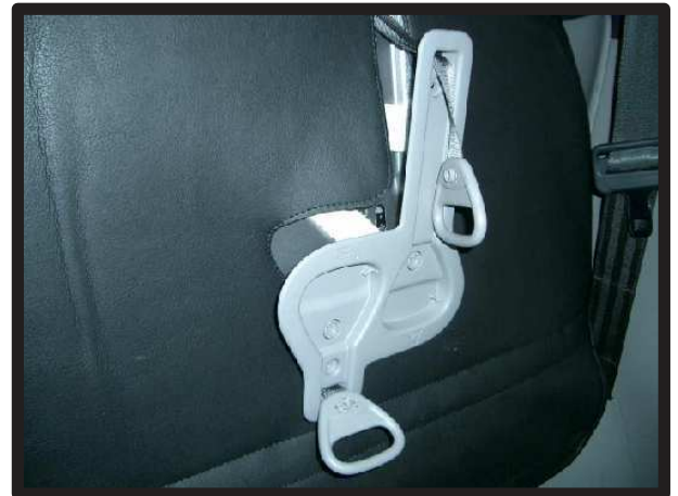
⑥座席の背面にはシートを持ち上げる際に使うレバーがあります。そのプラスチックカバーをドライバーを使って外します。
