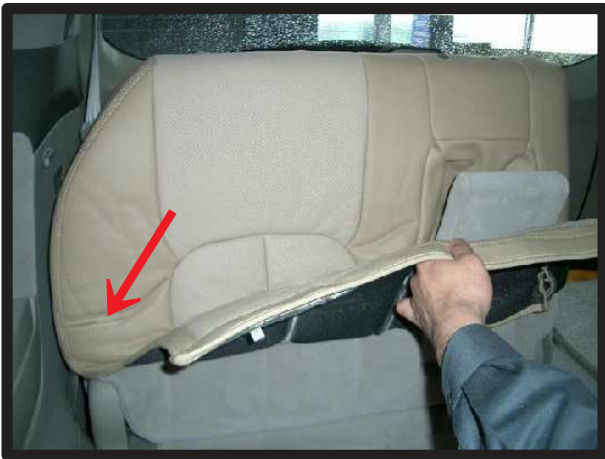
②矢印部分からリクライニング用レバーを取り出します。
