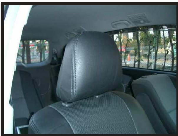
⑥ヘッドレストを背もたれに取り付け完成です。 2列目ヘッドレストも同様に取り付けます。
