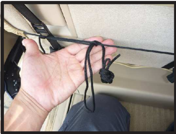
⑧通したヒモを引くことで座面下回りが締まります。締まった状態でヒモを結び留めます。
