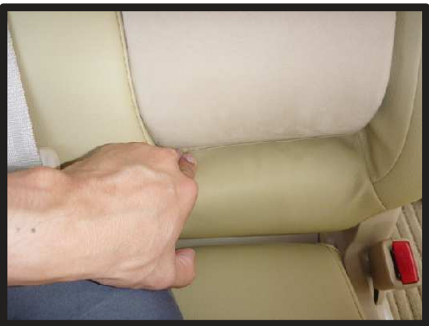
⑰両面テープで生地を固定すれば、アームレストを動かしても生地が浮かず、よりきれいに固定されます。 ※カバーを外した際にシート表皮に粘着剤が残る可能性があります。作業をされる場合は、予めご理解頂いた上で作業を行なって下さい。
