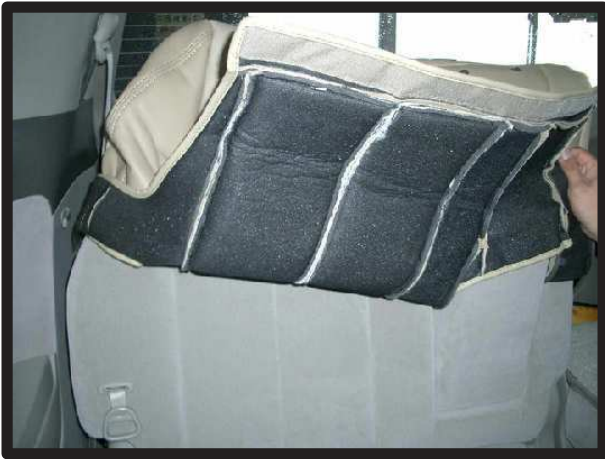
①シートカバーを半分ほどで裏返しラインを合わせかぶせていきます。
