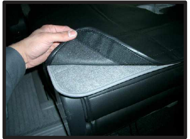
⑤背もたれカバー裏側をマジックテープで固定します。
