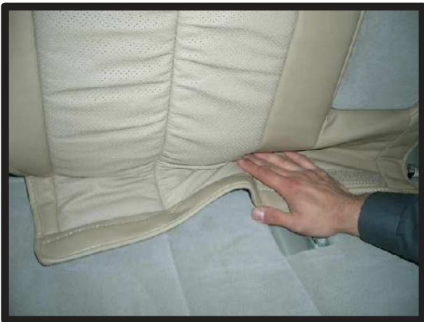
③背もたれと座面の間にシートカバーを入れ込みます。
