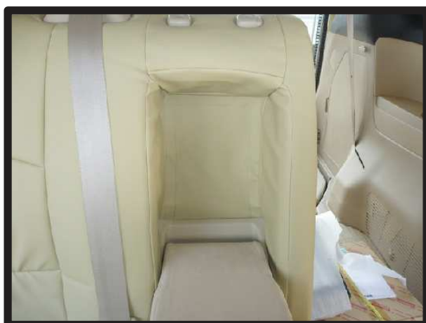
⑫アームレスト収納部は図のようになります。カバーを全て装着後、アームレストをきっちり収納した状態にしておけば、生地がシートに馴染みやすくなります。
