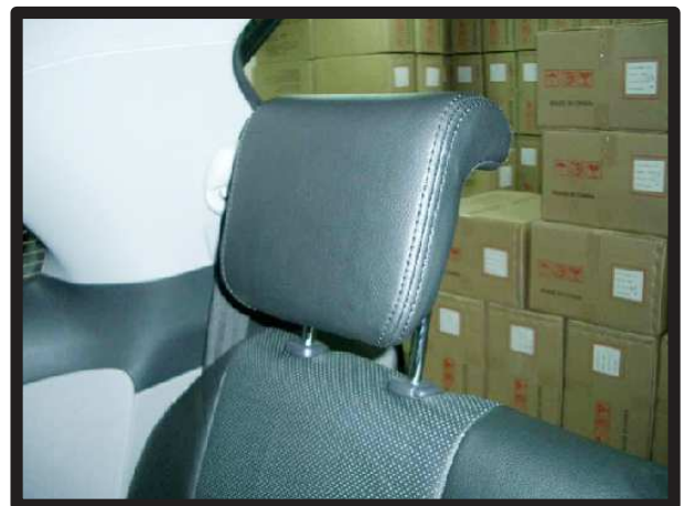
⑨ヘッドレストを背もたれに取り付け完成です。 2、3列目センターヘッドレストも形状は異なりますが、同様に取り付けます。
