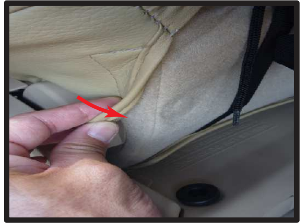
⑩座面を跳ね上げて、外側面の付け根辺りの生地を、直接シートに貼り付けて固定します。
