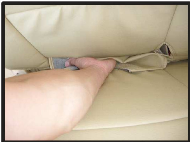
⑦背もたれと座面の間にカバーを入れ込みます。
