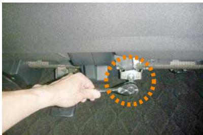
7 プラスチックの枠を外すとシートベルトを固定しているボルトがあります。ボルトをソケットレンチなどを使用して外します。ソケットは14mmを使用します。ボルトを外すとシート正面側からシートベルトが抜き出せます。
