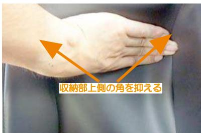
27 アームレストをシートに戻します。この際アームレスト収納部の生地が下に引っ張られるごとに生地が浮いてしまいます。アームレスト収納部の上側の生地をしっかりと抑えながら元に戻して下さい。
