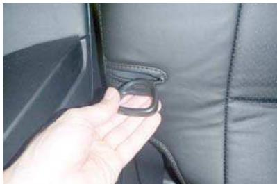
2 カバーの加工穴からリクライニング用レバーを取り出します。
