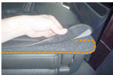
11 下側のマジックテープはシート地の端に沿って、直接貼り付けて固定します。
