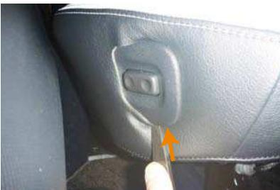
11 3列目電動シート車はカバーの外側面に開
