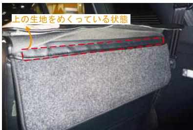
6 カバー背面上部の生地をめくり上げると、マジックテープが付いた生地があるので、ボード上部に貼り付けて固定します。この際、ヘッドレストの穴位置を合わせながら固定して下さい。
