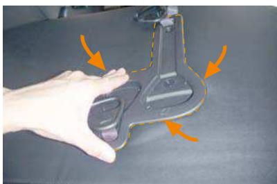
8 外したプラスチックカバーを、生地を挟み込み元通りに固定します。
