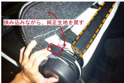
4 背面から引き出した生地に付いているマジックテープ（幅が広い方）をシートのふちに直接貼り付けて固定します。また、細い方の生地に付いているマジックテープは、純正の生地を付け根までめくり上げ、隙間に挟み込み固定します。
