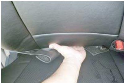
25 背もたれと座面の隙間に生地を入れ込みます。
