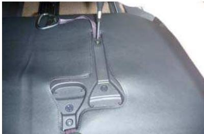
7 シート背面にシートを格納した状態から持ち上げる際に使用するレバーがあります。そのプラスチックカバーをドライバーを使用して外します。
