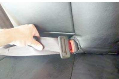
32 20ページ21番で取り出したシートベルトのバックルを、カバーの収納部から取り出します。取り出しづらい場合は図のようにシートベルトを一度バックルにはめ込み引き出して下さい。
