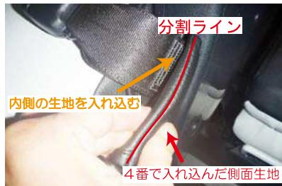
5 内側の生地をシートベルトとシートの隙間に入れ込みます。
