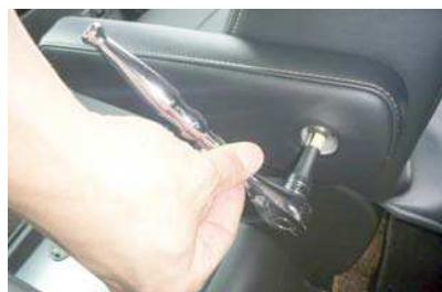
2 ソケットレンチなどを使用してボルトを外します。ソケットは14mmを使用します。ボルトを外すとアームレストが外れます。
