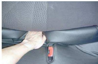
2 背もたれと座面の隙間に生地を入れ込み、入れ込んだ生地をシート背面から引き出します。
