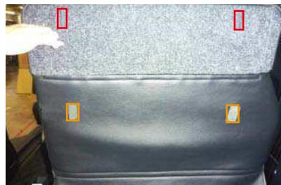
11 ボードを下ろした際、ボード裏に元から付いているマジックテープと、カバーに付いているマジックテープの位置が合っている事を確認して下さい。位置がずれている場合は、カバーを馴染ませ治して位置を調節して下さい。
