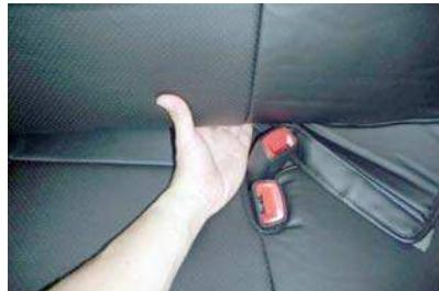
4 カバーをシート全体にかぶせて、背もたれと座面の隙間に生地を入れ込みます。
