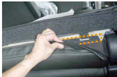
5 入れ込んだ生地を背面から引き出し、引き出した生地に付いているマジックテープを直接シートに貼り付けて固定します。
