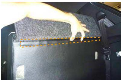
9 背面ボードをめくり上げた位置に付いているマジックテープをシート(ボードの付け根)に直接貼り付けて固定します。
