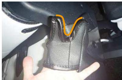
3 シートベルトバックルの収納部に図の生地を入れ込みます。図のくぼみ部分でシートベルトをかわします。
