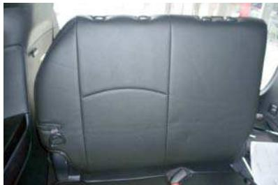
12 カバーのラインを整えて、3列目運転席側背もたれの完成です。助手席側も一部形状は異なりますが、同様の固定方法で取り付けます。
