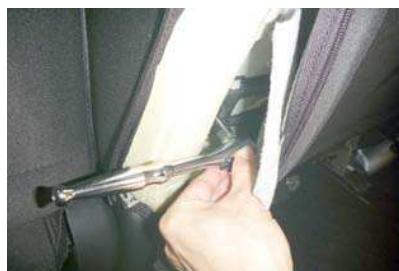
11 ソケットレンチなどを使用してナットを2本とも外します。ソケットは12mmを使用します。
