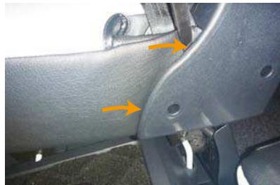
4 カバー内側面の生地を、ヘラ等を使用してプラスチック部の隙間に入れ込みます。
