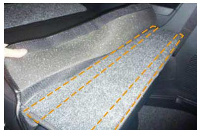
10 カバー背面下部の生地裏に付いているマジックテープ2本をシートに直接貼り付けて固定します。
