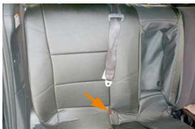
21 カバー内側面のファスナーを開けます。カバーをシートのラインに合わせて全体にかぶせます。
