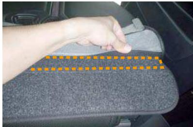
10 カバー背面下の生地にマジックテープが上下2本付いています。上側のマジックテープをシート地の折れ目に沿って、直接貼り付けて固定します。
