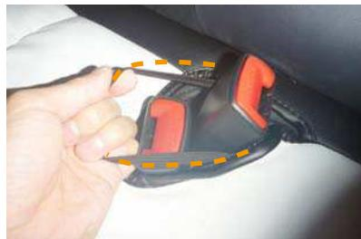
6 運転席側のシートベルト収納部分のカバーにはゴムが付いています。ゴムをバックルに巻き付けるようにして通し、付け根部分で固定します。
