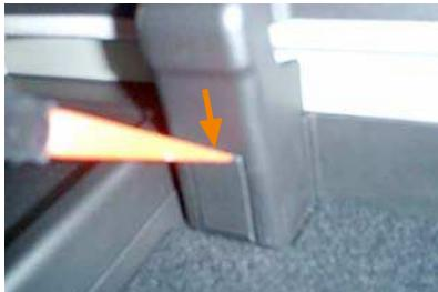
2 プラスチックカバーは図の矢印の箇所にあらゆる凹みにへらなどを差し込み、フタを開けます。さらに中のネジをドライバーを使用して外すと、コンソールのフタ部分が外れます。
