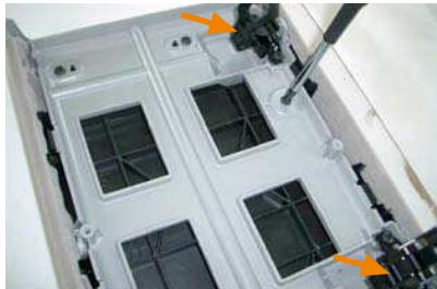
4 内ブタを外すとフタの裏側にもネジがあります。ネジを外して、さらに矢印部分の固定用金具も外します。
