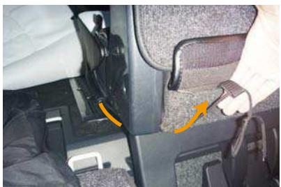
8 3列目電動シート車は図の位置にヒモを通します（図は内側面）。
