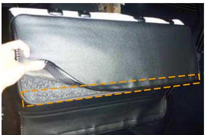
8 ボード部分に6番でめくり上げた生地に付いているマジックテープを直接貼り付けて固定します。
