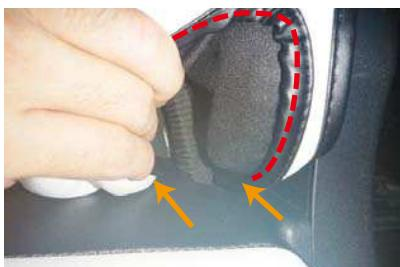
2 背もたれと座面の隙間に生地を入れ込みます。内側に図のような配線が通っている為生地の切れ込みで左右に避けるようにして下さい。
