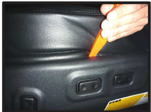
⑥側面の生地をヘラ等でプラスチックカバーの隙間に入れ込みます。
