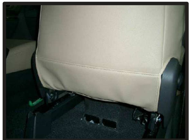
⑫S字フックで固定すると、このようになります。カバーのラインを整え1列目背もたれの完成です。
