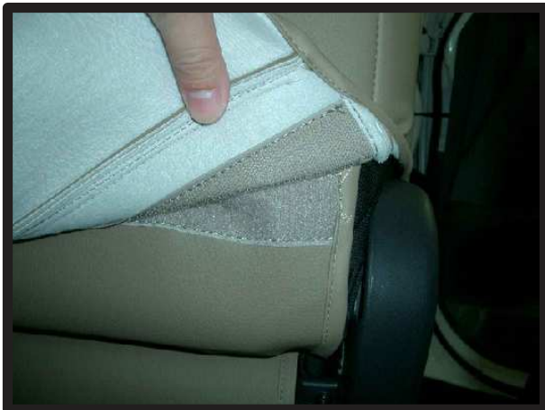
⑧⑥で引き出した生地を、背もたれ背面の生地とマジックテープで固定します。
