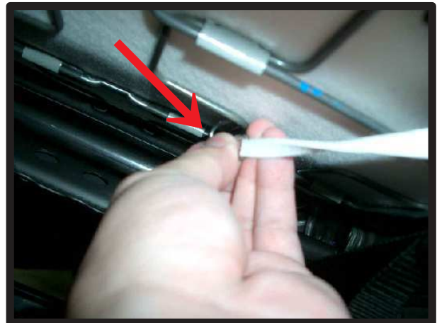
⑪生地を座面の下に潜り込ませ、座面下の金具にS字フックを引っ掛けます。
