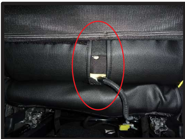
⑨シートヒーター装着車は、⑥で引き出した生地を固定する際に、図のように配線をおかして下さい。
