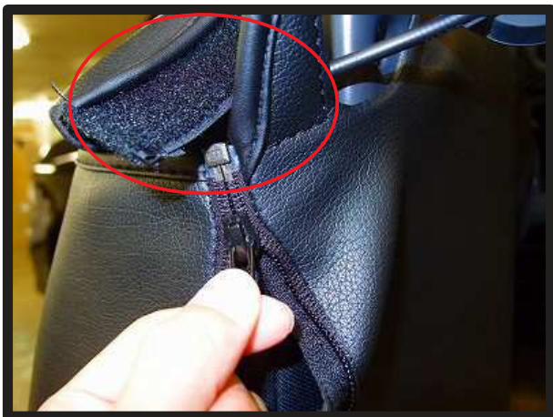
⑧背面のファスナーを閉じます。 ファスナーの上に付いているマジックテープ（赤丸内）を固定します。
