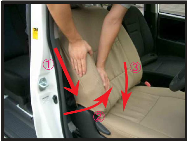
⑦①～③の順にカバーをシートに馴染ませるように、側面のシワを無くします。
