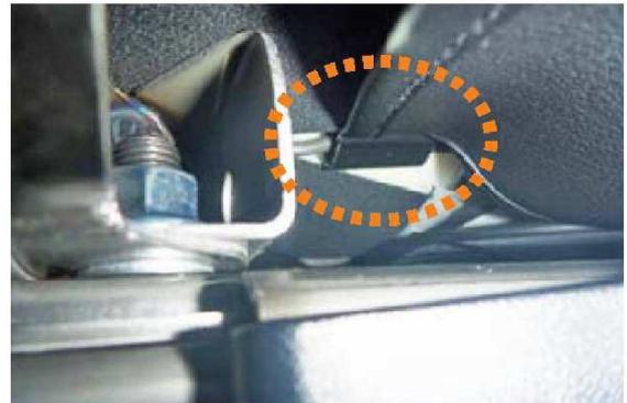
**10** フックはシート裏の金属部分に引っ掛けて固定します。シート裏は生地で覆われていますが、その生地を固定している金属部分に引っ掛けて固定します。
