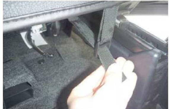
**10** シート背面からベルトを引き出して、5ページ4番で引き出した生地に付いているバックルに通します。
