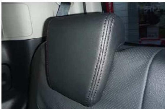
**5** ヘッドレストをシートに戻します。カバーのラインを整えて、3列目ヘッドレストの完成です。
