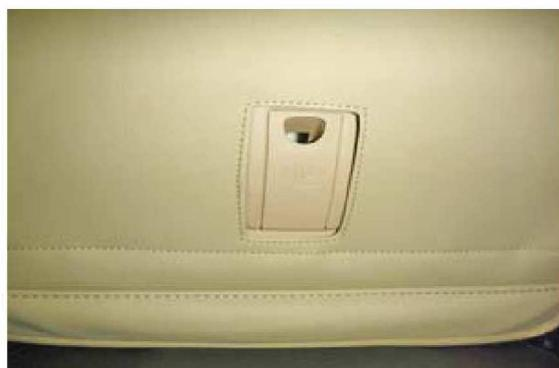
**10** 図のプラスチック部にカバーの加工穴を合わせるように調節します。
