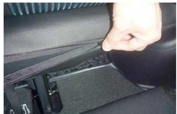
**11** 8番で引き出した生地とカバー背面の生地を寄せ合いながら、ファスナーを慎重に閉じて固定します。ファスナーの端はカバーの内側へ入れ込みます。
