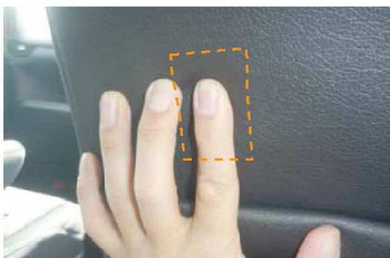
**3** 背もたれカバーを装着します。コンビニフックを元に戻すのに穴を開けますので、加工後は背もたれカバーをずらしたりできません。穴開け加工をする前に、背もたれカバーにすれなどが無いかしっかりと確認して下さい。カバーの上から指でコンビニフックの固定位置を確認します。
