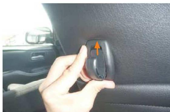
**6** コンビニフックをシートに戻します。2番の図を参考に下から上へ、上のツメをまず引っ掛けて、押し込み下のツメを引っ掛けます。固定後はコンビニフックを軽く引っ張りしっかり固定できているか確認して下さい。
