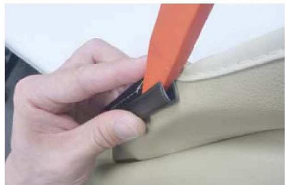
**14** プラフックを固定する前に、フックの隙間にヘラなどを差し込み、フックの隙間を少し広げておくとフックが引っ掛かりやすくなります。
