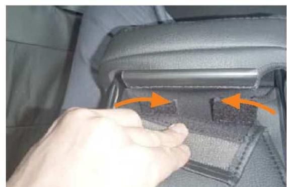
**3** ヘッドレストをシートから外します。ヘッドレスト底面で生地を内へ寄せながらマジックテープを固定します。
