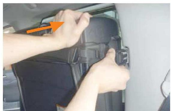
**9** 3列目シートを跳ね上げて、車体側にロックをする際、ロックが車体側まで届かない場合は、図のようにシートの角を押して固定するようにして下さい。
