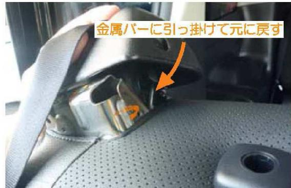
**10** プラスチック部を元に戻します。プラスチック部内側の背面にあるフックを、土台側の金属バーに引っ掛けて元に戻します。
