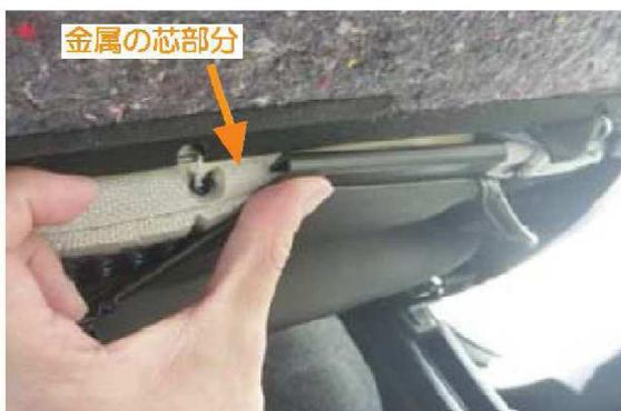
**12** 8ページ8番で引き出した生地に付いているプラフックを、シート表皮を固定している金属の芯部分に引っ掛けて固定します。
