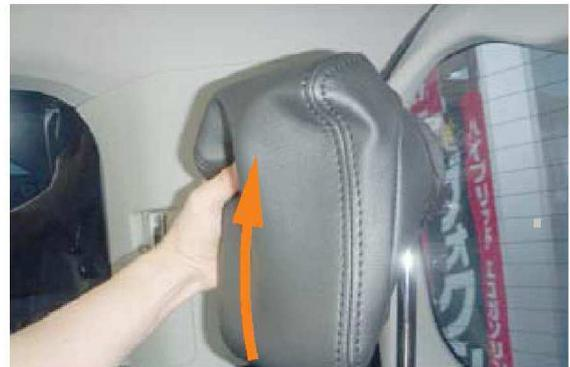
**1** 3列目両サイドのヘッドレストは、図のようにヘッドレストの先端にカバーを引っ掛けるようにして、下から上にかぶせます。
