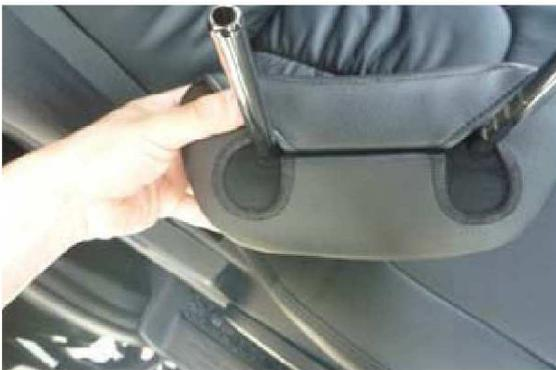
**8** 2列目ヘッドレストは運転席側と助手席側で一部形状は異なりますが1列目と同様に取り付けます。図は運転席側の底面の図です。カバーを装着しやすくする為に軸回りを大きくしています。
