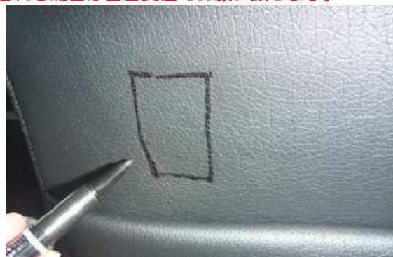
**4** 確認した位置に図のように印を付けます。始めは若干小さめに印を付けるようにして下さい。
