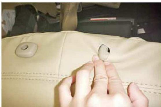
**2** カバーの加工穴から生地伸びを利用してヘッドレストの台座を取り出します。
