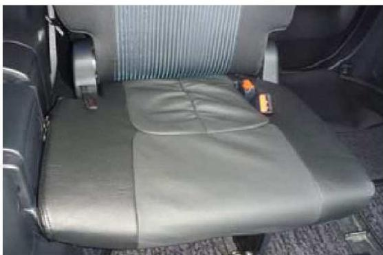
**15** カバーのラインを整えて、3列目運転席側座面の完成です。助手席側も一部形状は異なりますが、同様に取付けます。
