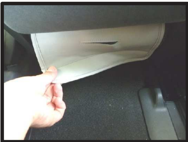
⑫センターアームレストの背面部分はチャイルドシート固定用のバーのある位置に、カバーの加工穴を合わせて、マジックテープで直接シートに貼り付け固定します。
