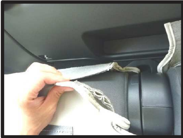
⑧引き出した生地を、カバー背面下の生地とマジックテープで固定します。
