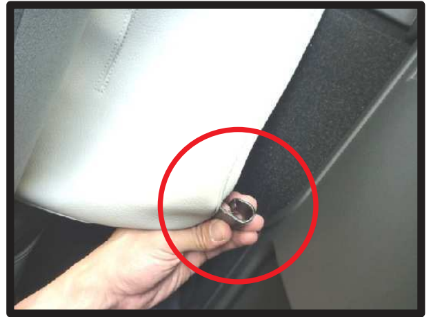
⑬⑧で引き出した生地に付いているプラスチックフックをシート裏に引っかけて固定します。
