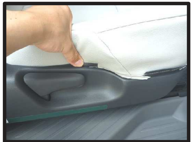
⑮カバー側面のプラスチックをシートとシートの土台のプラスチック部の隙間に入れ込みます。
