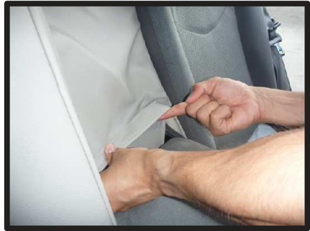
㉒引き出した生地とアームレスト収納部の下の生地を、マジックテープで固定します。
