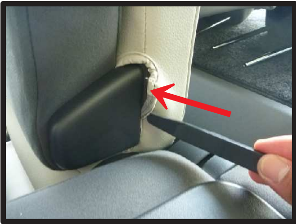
⑬シートの内側面です。図の隙間に生地を入れ込みます。
