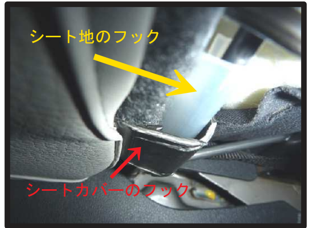
⑭フックはシート地を固定しているフックの上から引っ掛けて固定します。
