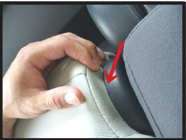
⑨シートの背面です。シート付け根部分に生地を入れ込み
