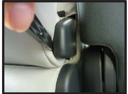
⑧アームレストの付け根部分の生地を 図の隙間に入れ込みます。
