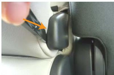
8 アームレストの付け根部分の生地を図の隙間に入れ込みます。
