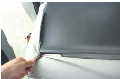
9 シート背面のバックボードの隙間に生地を入れ込みます。プラスチックの板を入れ込むことで、生地がはみ出さずに固定されます。
