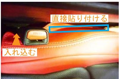
8 内側面の生地に付いているマジックテープをシートに直接貼り付けて固定します。後ろ側の生地はシートベルトバックルの付け根の隙間に、ヘラ等を使用し入れ込んで下さい。
