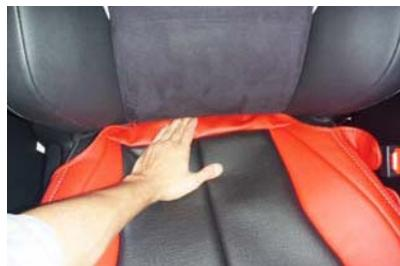
5 背もたれと座面の隙間に生地を入れ込みます。背もたれの角度を調節し、入れ込みやすい角度で作業を行って下さい。
