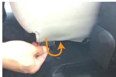
18 カバー内側面に付いている固定部材を13番を参考にして、シート裏で固定して下さい。
