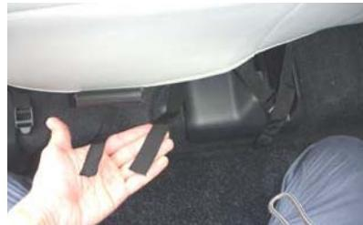
16 9ページ6番で通したベルトをシート前側から引き出します。引き出したベルトと、カバー前側に付いているバックルを固定します。
