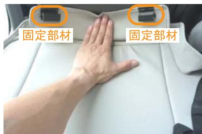
9 背もたれと座面の隙間に生地を入れ込みます。生地を入れ込む際に、固定部材でシートに傷が付かないよう慎重に作業を行って下さい。
