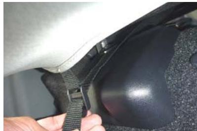
6 シート前方からベルトを引き出して、カバー裏側に付いているバックルと固定します。
