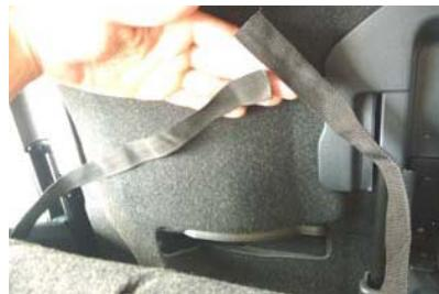
6 3番～5番で入れ込んだベルトを、シートを前方にスライドさせて、一旦シート背面から引き出します。引き出したベルトをシート裏から前側に通します。
