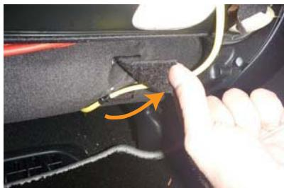
2 シート背面下にマジックテープでサイドエアバッグの配線が固定されている為、固定を外します。
