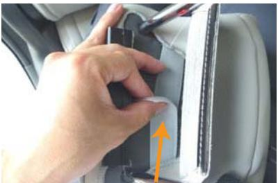
7 ヘッドレストをシートから外します。ヘッドレスト裏のマジックテープを、生地を内へ寄せながら固定します。
