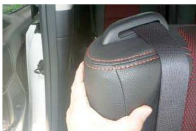
**5** カバーをシート全体にかぶせます。始めにシート肩口に生地がしっかりと馴染むように、シートに密着させていきます。
