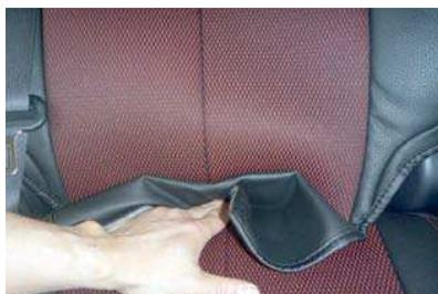
**6** カバーのラインに合わせてカバーをかぶせて、背もたれと座面の隙間に生地を入れ込みます。
