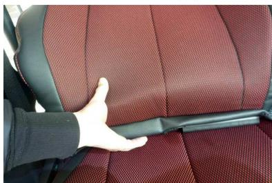
**9** 背もたれと座面の隙間に生地を入れ込みます。入れ込む生地にはフックが付いています。フックでシート地・カバーの生地を傷付けないようにご注意ください。
