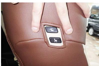
**11** カバーの加工穴と、シート内側面のボタンの位置が合っている事を確認して下さい。位置が合っていない場合は、カバーを馴染ませ直して、位置を合わせて下さい。
