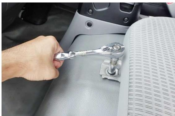
3 ソケットレンチ等を使用し、ボルトを外します。（ソケット12mm）
