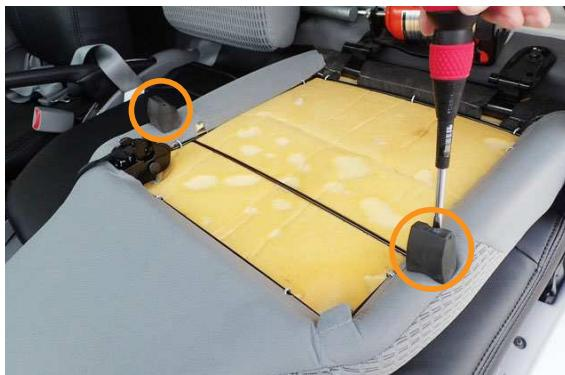
1 始めに、プラスドライバーを使用し、背面に付いているゴムパーツを取り外します。
