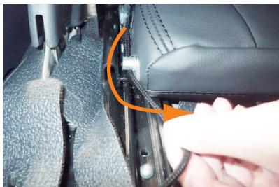
7 6番で通したヒモを、後ろ側から引き出します。引き出したヒモは、5番と同様にシートレールの上側に引っ掛けるようにします。
