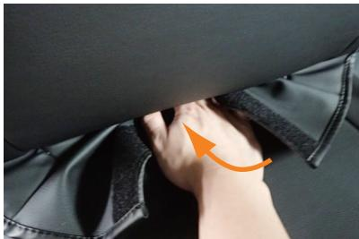
7 背もたれと座面の隙間に生地を入れ込みます。背もたれの角度を調整して入れ込みやすい角度で行って下さい。
