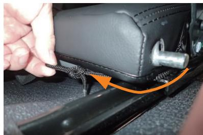
5 後ろ側へ通したヒモは、図のようにシートレールの上側に引っ掛けるようにします。
