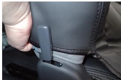
4 シートのラインからずれないようにカバーを左右均等に引き下げてシート全体にかぶせます。カバー側面のリクライニングレバーを避けるようにして下さい。
