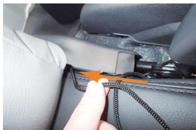
6 カバーの内側面に付いているヒモは、背もたれのヒンジ部の内側に沿わせ、後ろ側へ通します。
