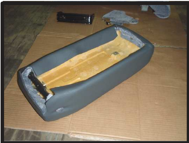
⑧カバーの穴位置とアームレストの穴位置を合わせてかぶせます。
