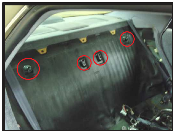
⑦図の丸印のフックに背もたれ背面の 金属バーが引っかかっています。
