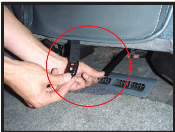
⑨ベルトを背面側に引き出し固定します。
