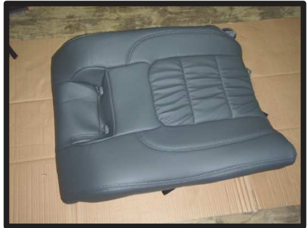
⑬ラインを整えます。 取り外した逆の手順で元に戻して、 2列目背もたれの完成です。
