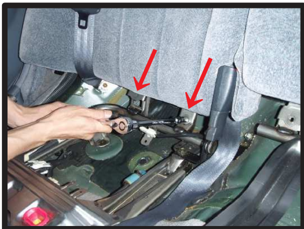
④背もたれ下側にボルトがあります。 ラチェット等を使用し取り外します。
