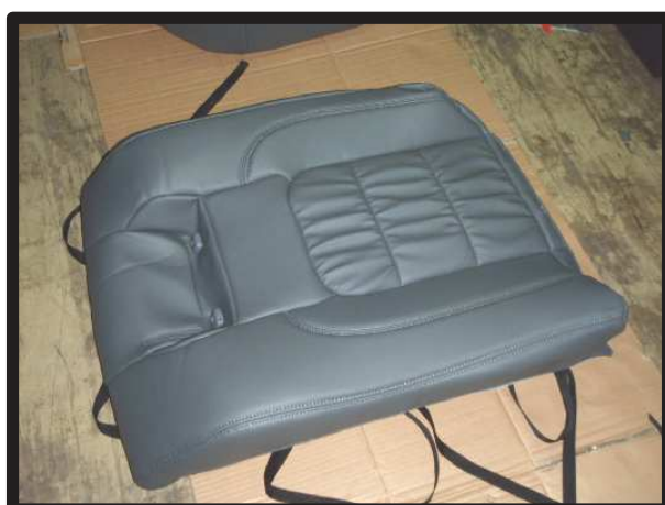
⑨背もたれのラインに合わせてカバー をかぶせます。
