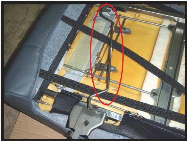
⑪背もたれを裏返して、カバーの上下 左右に付いているベルトで固定しま す。 可動する金属バーの下にベルトを通 して固定します。
