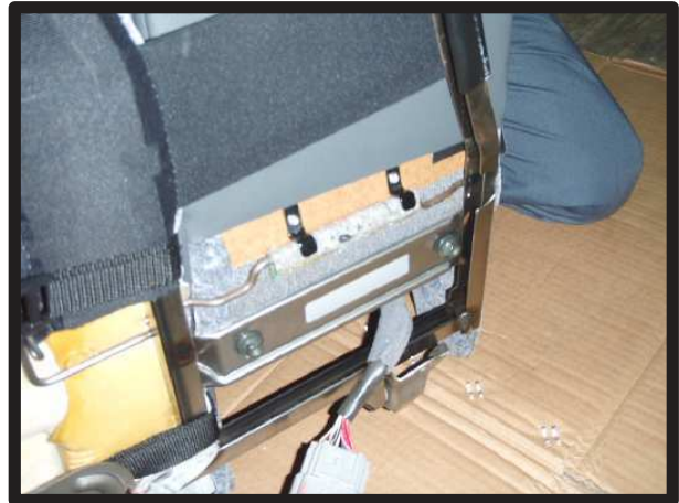
㉔アームレストを背もたれに戻します。外した時と逆の手順で固定します。図を参考にコネクタを引き出す位置にご注意下さい。
