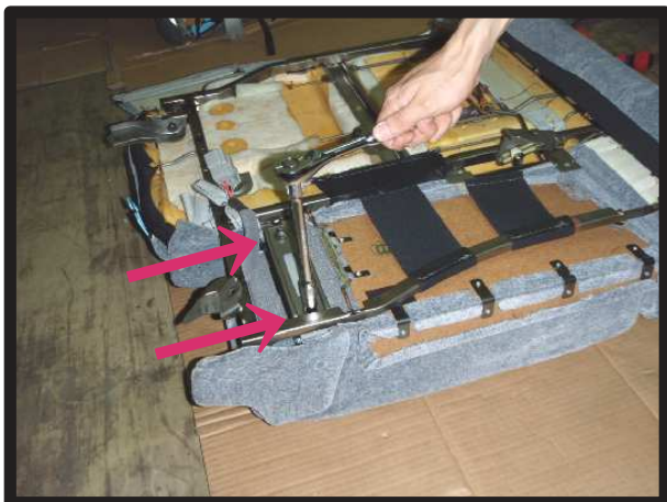
①背もたれ裏側のアームレスト固定用ナットをラチェット等を使用して外します。
