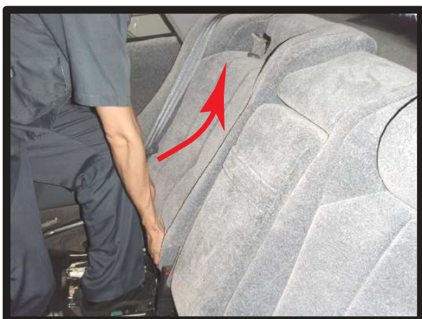
⑥背もたれを外します。 上にずらすようにして、持ち上げま す。 車体に傷を付けないよう、慎重に作 業を行って下さい。
