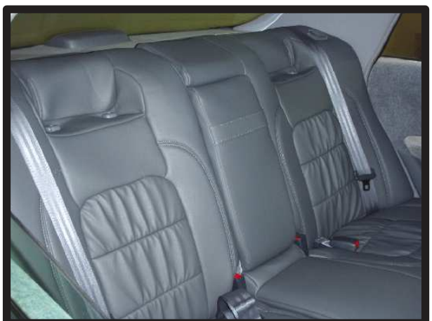
㉖背もたれを車体に戻します。パワーシートのコネクタを付け忘れないようご注意ください。外したときと逆の手順で固定します。
