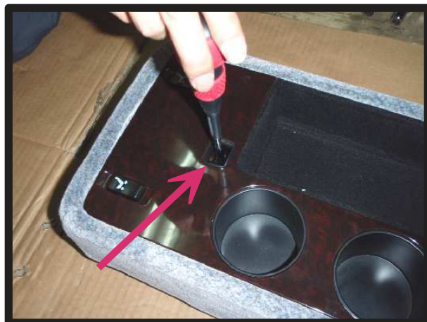
⑥下パーツのボックスを外します。 図のカップホルダーの上にネジがありますので外します。
