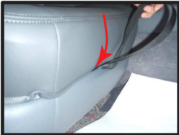
⑧カバーの前後に付いているベルトをプラスチックカバーの間に入れ込みます。
