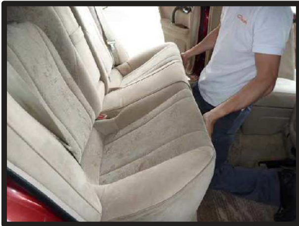
①座面は手前を持ち上げるようにして取り外します。
