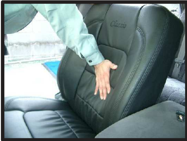
⑧カバーをシートに馴染ませるように密着させ、しわを無くします。
