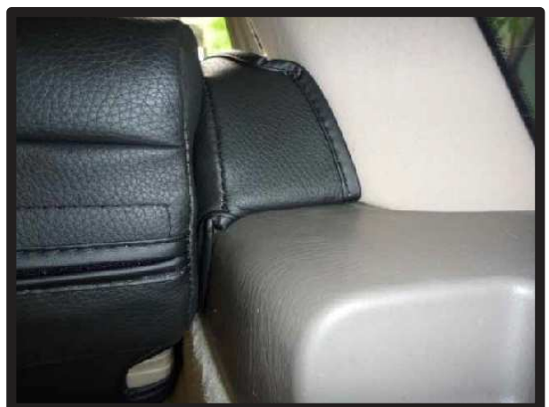
⑥取り外した逆の手順で、車体に戻します。カバー上端の先の丸い生地は本体取り付け後に、車体との隙間に入れ込みます。
