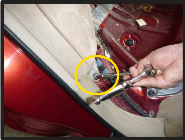
①丸印のナットを外し、上へ持ち上げると本体を取り外す事が出来ます。
