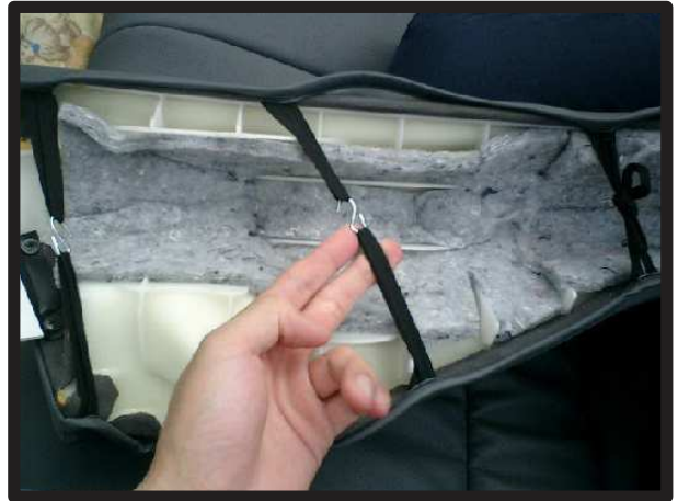
④背もたれ横パーツには、タグにSWと表記されたカバーを使用します。カバーをかぶせ、ゴム同士を付属のS字フックで固定します。
