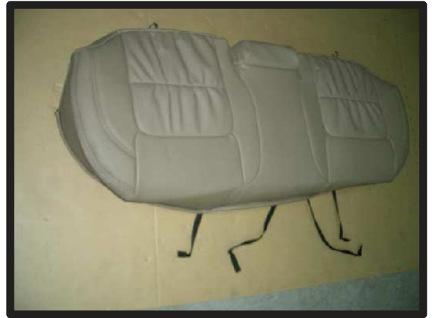
④カバー表面をシートのラインに合わせて、整えます。
