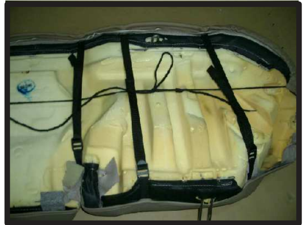
⑤シートを裏返し、前後のベルトを固定していきます。 カバー両端のヒモは、ベルトの下を通るようにして、しっかりと引き絞って結びます。
