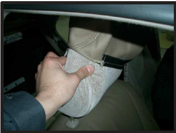
③ヘッドレスト本体を、押し潰すようにしてカバーをかぶせていきます。
