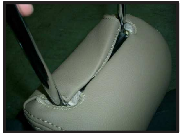
⑥カバーの取り付けは、プラスチックのフック同士で固定します。
