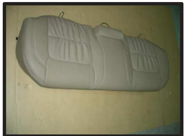
⑥カバー表面を整え、2列目座面の完成です。 座面は、背もたれ側のカバーを装着後に、車体に戻します。
