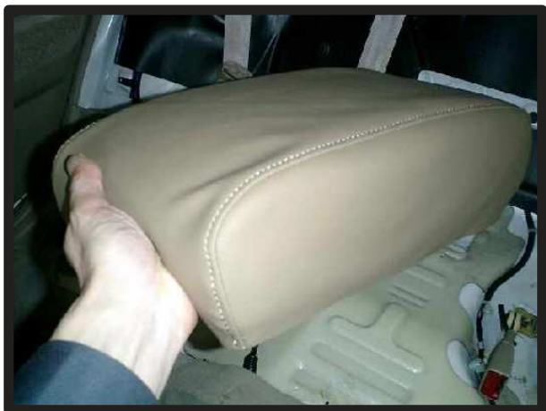
④フタのラインに合わせて、カバーをかぶせます。
