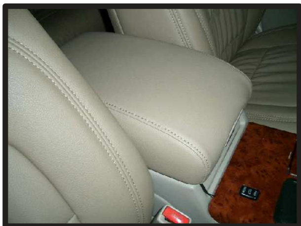
⑨カバーの表面を整え、コンソールボックスの完成です。
