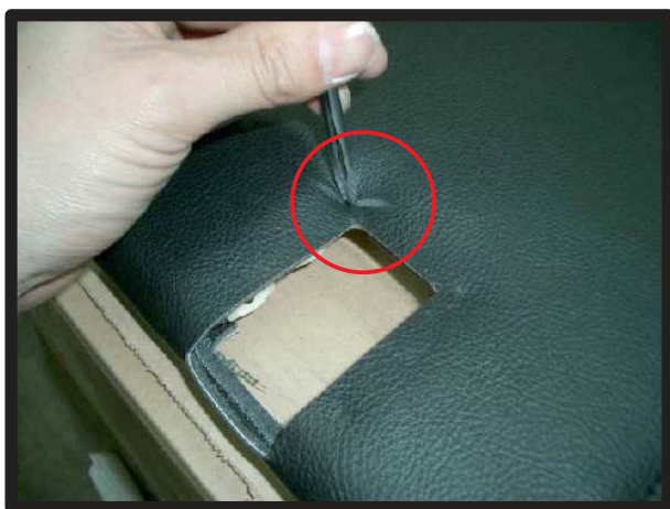
⑰カバーのレバー部のネジや突起部のある場所に、あらかじめ穴を開けておきます。
