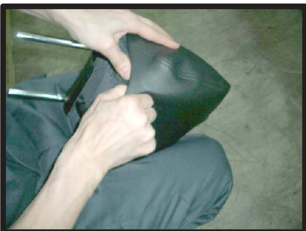
③ある程度引き下げましたら、ヘッドレストを背もたれから取り外し、カバーを下までかぶせます。
