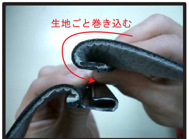
⑥（断面図）平らなプラスチック部分を写真のように内側へ折り返します。
