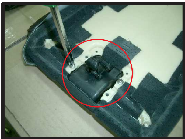
⑮フタの開閉レバー部分を取り外します。 +ドライバーを使用します。
