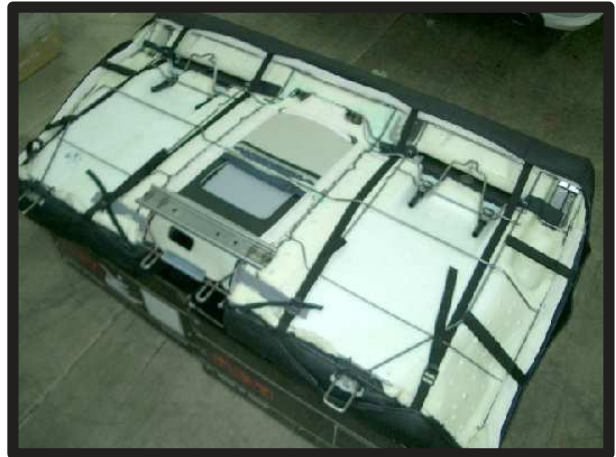
⑩シートを裏返し、上下のベルトを固定します。左右のマジックテープは適当な軸に巻き付けるように固定します。
