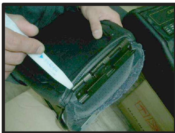
⑱ボックスとの繋ぎ目周辺のカバーは金具の下側に潜り込ませます。(金具が自由に動く程度に潜り込ませます。)
