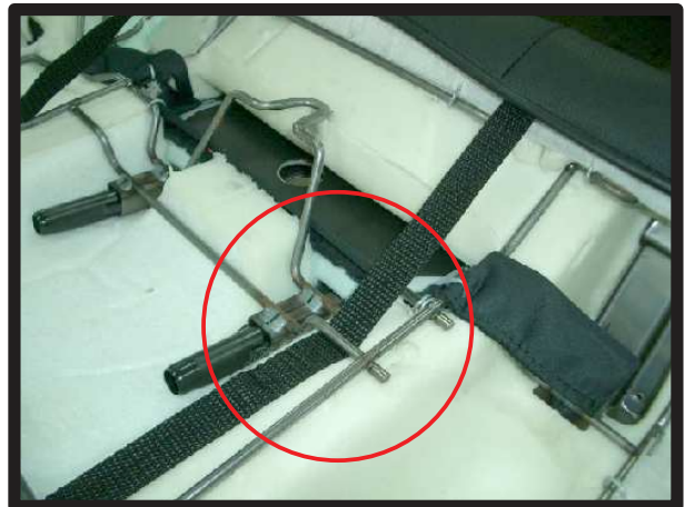
⑪ベルトを固定する時の注意点 背もたれを車体に取り付ける際、ベルトが邪魔にならないように、骨組みとスポンジの間に挟み込むようにベルトを通します。
