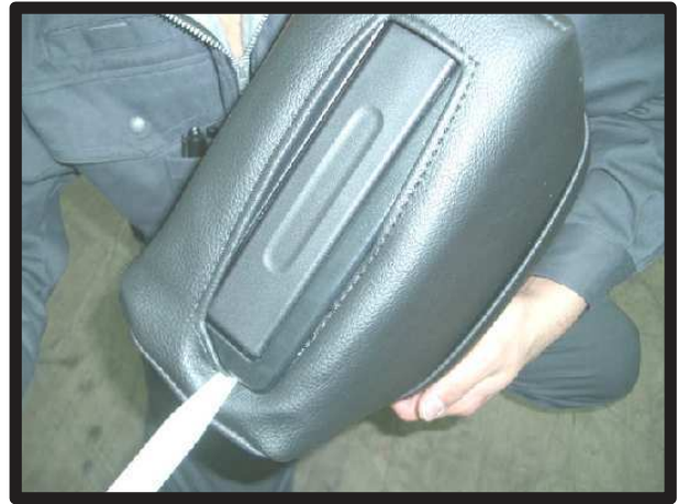
⑩収納式カップホルダー部分は、ヘラ等を使用し、生地を隙間に入れ込んでいきます。
