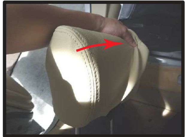
⑩2列目ヘッドレストは、まず片側にカバーをかぶせます。この際、しっかりとラインに合わせるようにします。
