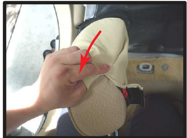
⑪生地伸びを利用し、ヘッドレスト本体を圧縮しながら反対側にカバーをかぶせます。
