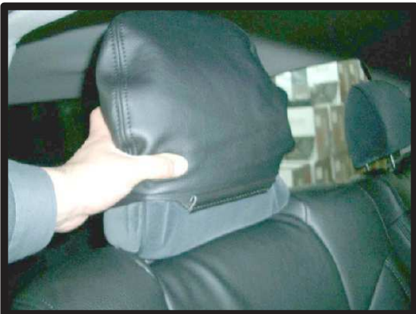
②左右均等に引き下げていきます。ヘッドレスト本体を圧縮しながら作業を行います。
