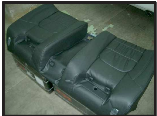
⑫カバー表面を整えながら、背面のベルトの引き具合を調節します。アームレスト装着後に、シートを車体に取り付けます。
