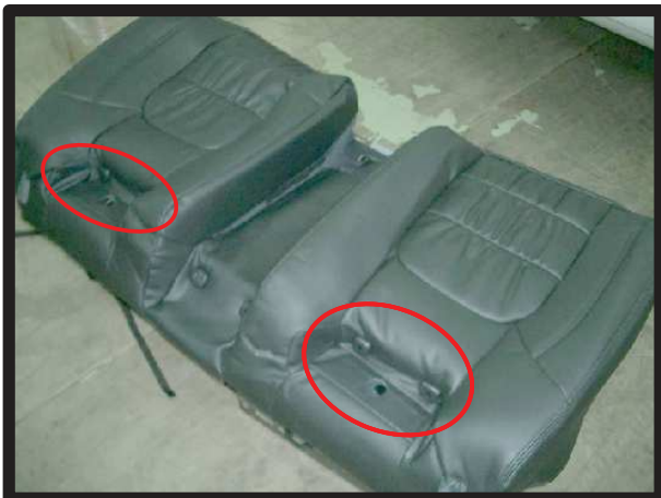
⑨ヘッドレストの台座部分を、1列目と同様に取り出し、カバー表面を整えます。
