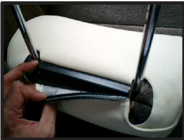
③裏面を向けて、プラスチックのフック同士を固定します。
