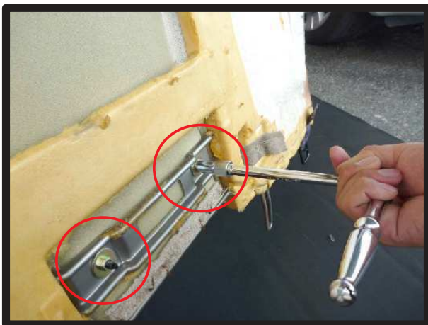
⑨背もたれを車体から取り外し、作業の行いやすい場所へ移動します。背もたれ裏側のナットを外し、アームレストを取り外します。
