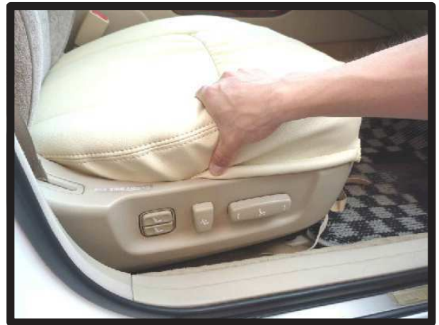
⑤側面の生地を、座面のプラスチック部の隙間に入れ込みます。
