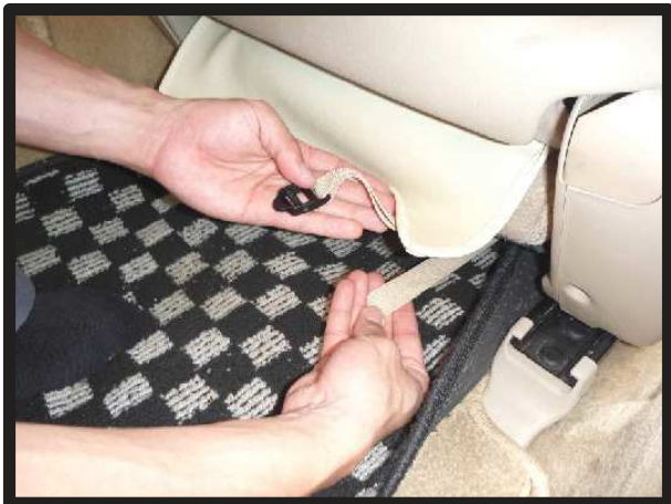
⑧⑥で引き出したベルトを、座面底部を通し、後ろ側で図のようにバックルを使用し固定します。
