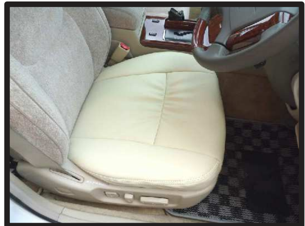
⑪カバー表面を整え、1列目座面の完成です。 助手席側も同様に取り付けます。
