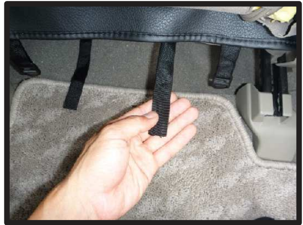
⑩座面カバー前方にベルトが付いています。ベルトは座面裏を通して、シート背面から引き出します。
