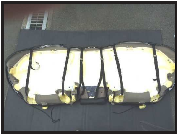
⑧シートを裏返して、シート裏で前後のベルト6本を固定します。
