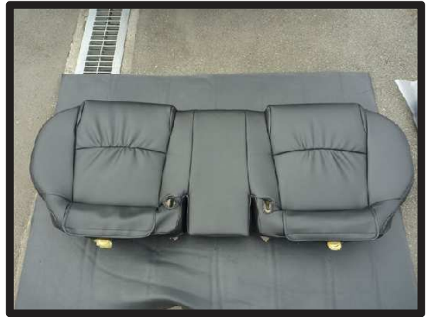
⑩カバーのラインを整えて2列目座面の完成です。 シートはカバーの取り付けが全て終了後に元に戻すようにして下さい。
