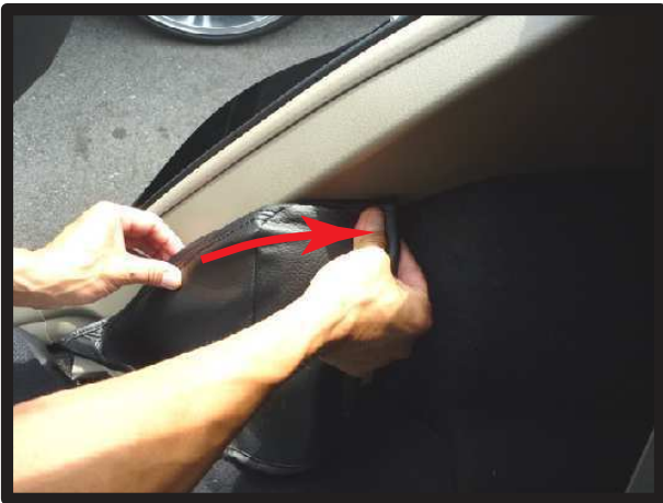
⑤矢印の方向に生地を入れ込みます。 サイドパーツ全体を包み込むようにカバーをかぶせます。
