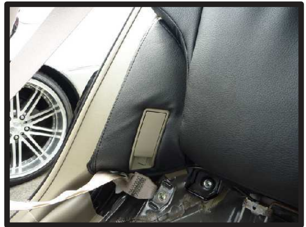
⑧レバーを元通りに取り付け、シートベルトのガイドを元に戻し、サイドパーツの完成です。
