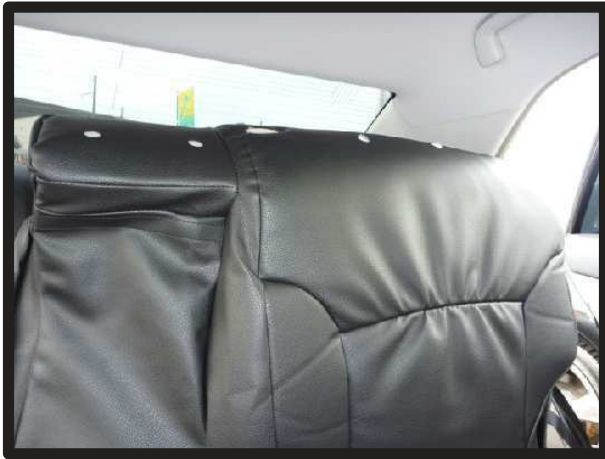
⑦背もたれカバーをかぶせます。 ※ヘッドレスト固定式の背もたれは、 ヘッドレストの頂点までしっかりと カバーをかぶせて下さい。
