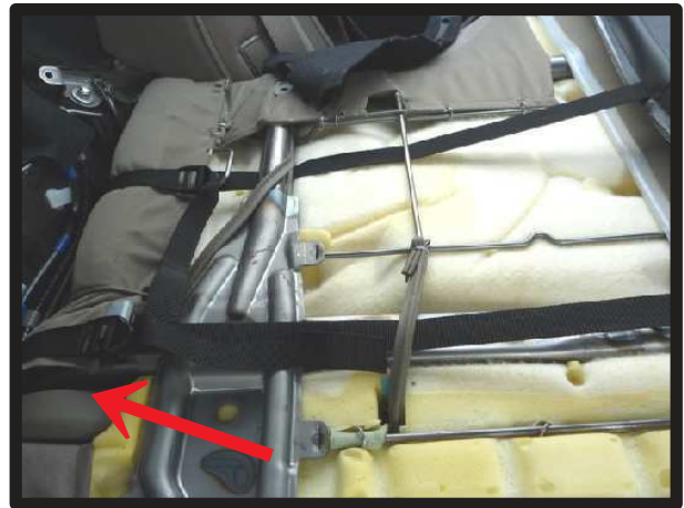
⑪シート背面からカバー上下のベルト を固定します。ベルトは金属フレー ムの下を通すようにして矢印部の固 くなっているシートの上を通すよう にして下さい。
