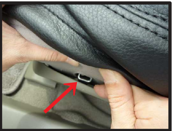
⑨助手席側には⑧の作業の際にシートから金属部が出ていて生地を入れ込みにくくなっています。プラスチック部を外に広げながら生地を慎重に入れ込んで下さい。
