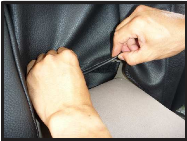
㉑引き出した生地と背もたれカバーの アームレスト収納部を、マジックテ ープで固定します
