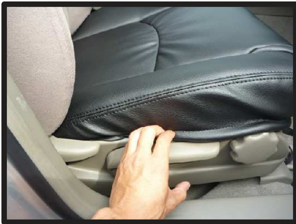
⑧シート側面の生地をプラスチック部に入れ込みます。ヘラのようなものを使用すると作業が行いやすくなります。
