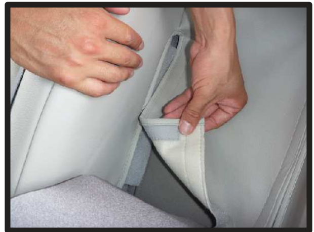
⑫アームレスト裏側のパネル部分のマ ジックテープを固定します。
