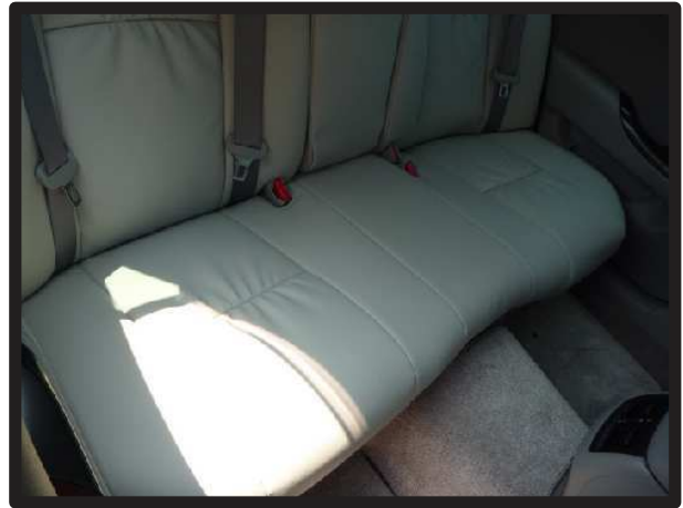
⑦2列目座面の完成です。 シートを車体に戻す作業は、背もたれを完成させた後に行います。
