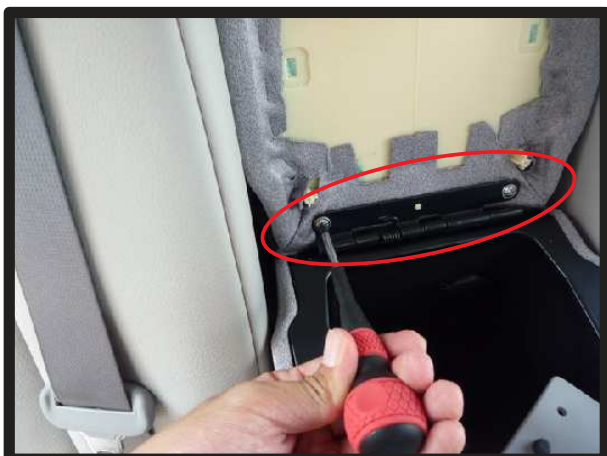
②プラスチック部分の下にネジが2本あります。ネジを外します。外した上フタは背もたれ側に寄せておきます。
