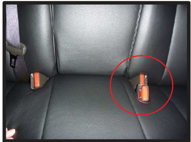
H20.2~21.3までの車 (0188・0189) 座面○部のシートベルトバックルが縦に並んでいます。
