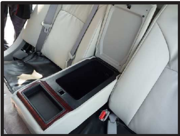
⑨カバーのラインを整え、外したネジを元に戻して、アームレスト下パーツの完成です。
