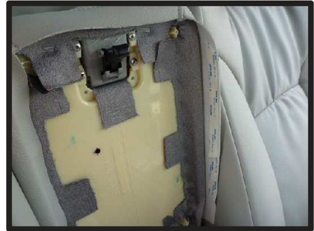
⑪両面テープ等を使用して、上フタにカバーを固定します。
