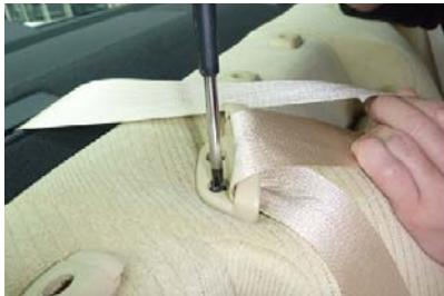
1 始めに、中央席用のシートベルトの台座をプラスドライバーを使用し取り外します。
