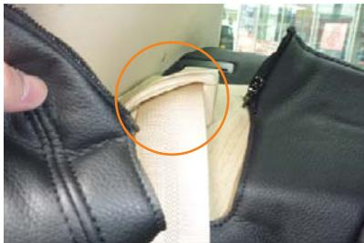
3 カバーの肩口に付いているファスナーを外し、シート肩口のシートベルトの台座をかわすようにします。
