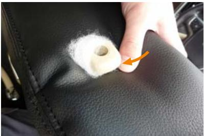
5 カバーの加工穴から、ヘッドレストの台座部を取り出します。生地の伸びを利用して横から潜り込ませるように取り出します。
