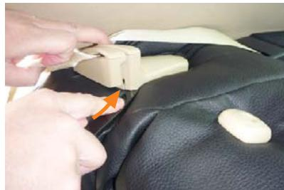
6 4番でシートベルトの台座をかわした生地を、台座の隙間にに入れ込みます。
