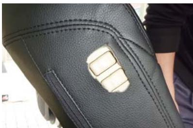
17 運転席側と同様にカバーを取り付けます。カバーの上からスイッチ部の位置を探り、図のようにカバーに穴開け加工します。
