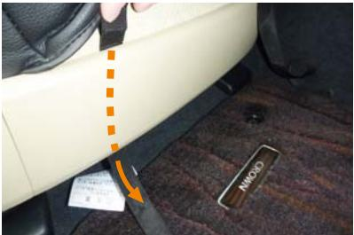
7 カバー前部に付いているベルトを、シートとプラスチックパーツの隙間を通しておきます。
