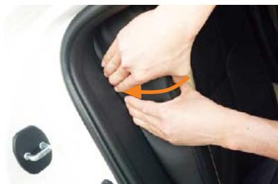
8 シート外側面と車体の隙間に生地を入れ込みます。
