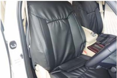
4 カバー両側面のファスナーを開いた状態でシートのラインに合わせかぶせます。
