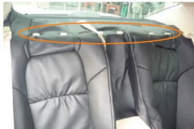
5 1列目と同様にカバーの加工穴からヘッドレストの台座を取り出します。
