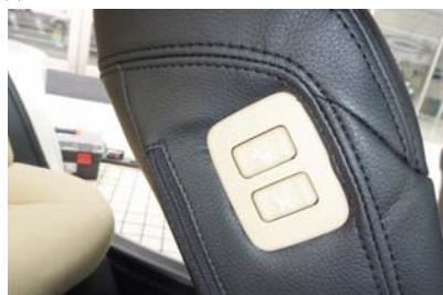
16 助手席背もたれ内側面には、パワーシート操作用のスイッチがあります。スイッチはカバーで覆われていても使用出来ますが、カバーに穴開け加工する事でスイッチ部を取り出す事が出来ます。
