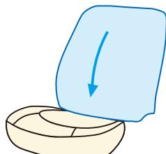
背もたれ部分のシートカバーを装着する前に、付属のビニールを被せます。この際、後で補助ビニールを引っ張り出しやすいように、カッターで両サイドに切り込みを入れておきます。
