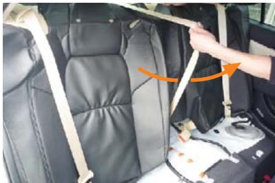
2 カバーをシートにかぶせます。中央のシートベルトの内側にカバーを通します。
