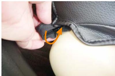
8 閉じたファスナーの先は、図のようにカバーの内側へ入れ込むようにします。
