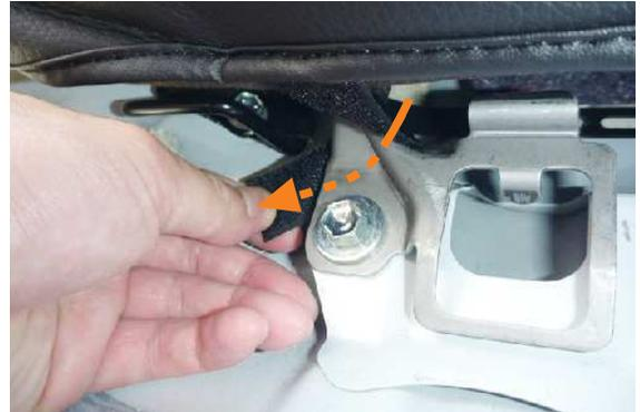
**10** シート下部の図の位置に、カバーに付いているマジックテープベルトを巻き付け、固定します。
