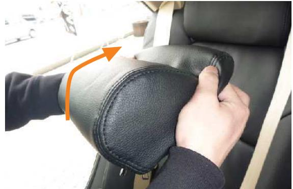
**10** 2列目中央席ヘッドレストも同様に、台座から取り外し、前側から後ろ側へカバーをかぶせます。
