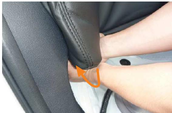
**4** 生地伸びを利用して、シート下側の角にカバーを引っ掛けるようにかぶせます。
