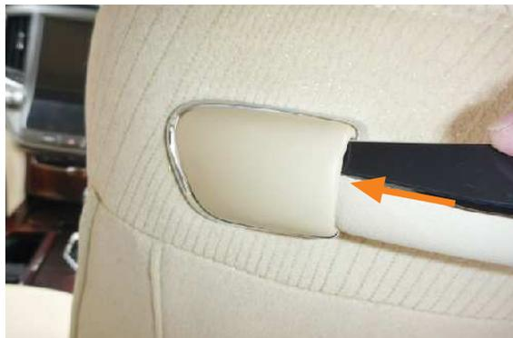
1 始めに、シート背面のバックグリップを取り外します。図の隙間にヘラ等を差し込むとカバーが外れます。
