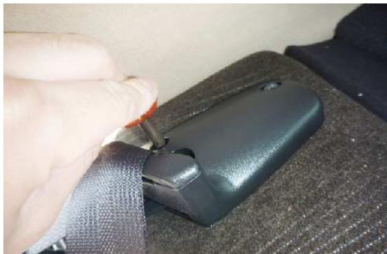
**1** 始めに、肩口にあるシートベルトの台座をプラスドライバーを使用し取り外します。
