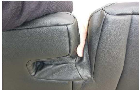
**11** 助手席側と中央席のシートベルトバックル収納部のラインに合わせ、カバーを整えます。
