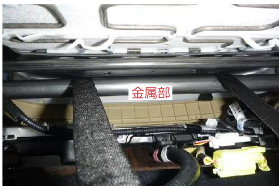
**8** 図はシート後方から見たシート底面です。7番で通したベルトを、シート底面を通し後ろ側へ引き出します。この際、図の金属部の上にベルトを通すようにして下さい。
