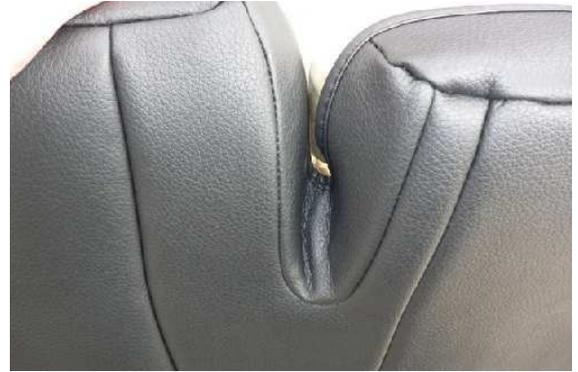
**10** 運転席側のシートベルトバックル収納部のラインに合わせ、カバーを整えます。
