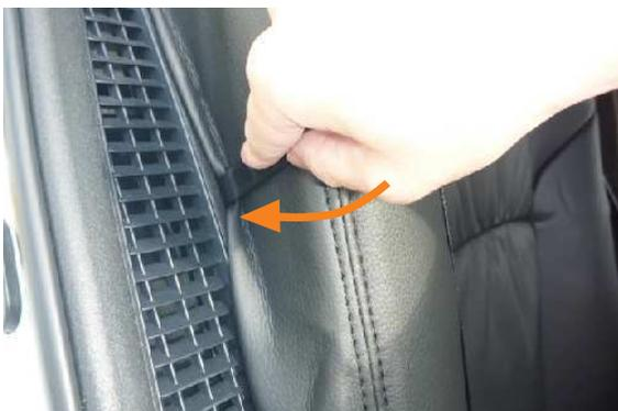
**9** シート外側面と車体の隙間に生地を入れ込みます。
