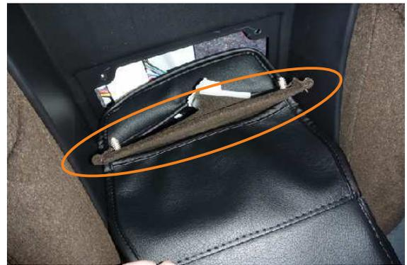
**11** めくり上げた生地をカバーの加工穴を通してから、元に戻します。
