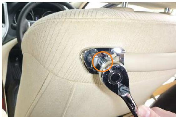
2 カバーを外すと、中にボルトがありますので、ソケットレンチを使用してボルトを外します。
