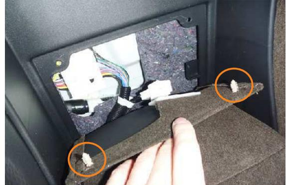
**10** フタは、背もたれ側にも固定されていますので、図の2ヶ所のピンを引き抜き、生地をめくり上げます。
