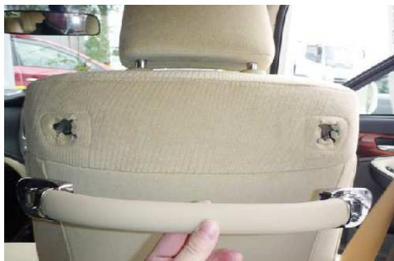
3 左右のボルトを外すと、図のようにバックグリップが取り外せます。
