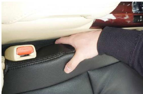
**5** シートの内側面に付いているシートとコンソールの隙間を隠す生地の上から、カバーをマジックテープでシートに直接固定します。
