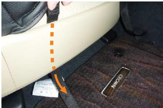
**7** カバー前部に付いているベルトを、シートとプラスチックパーツの間に通します。
