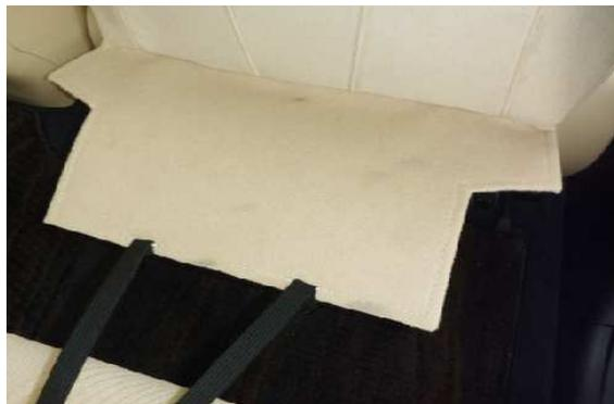
**1** 始めに、シート背面から座面裏側を覆っている生地を外します。生地はゴムでシート裏に固定されています。
