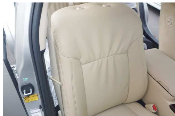
11 カバーのラインを整えて、1列目運転席背もたれの完成です。助手席側も同様に取り付けます。
