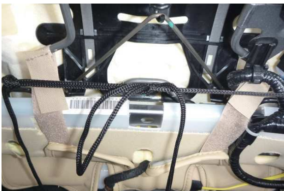
8 通したヒモを引き絞って、結び留めます。
