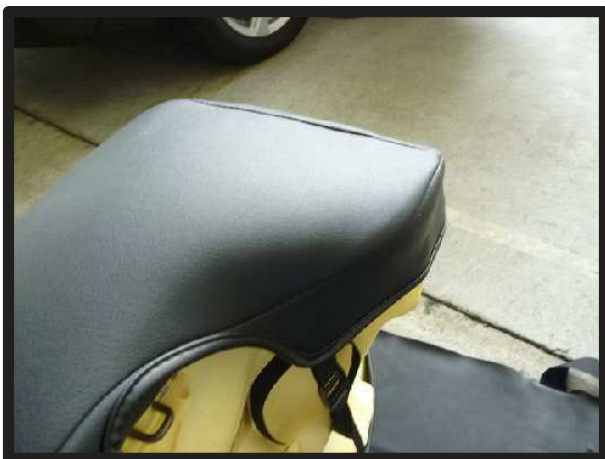
⑨角を整えて、全体を馴染ませるようにシワを伸ばします。
