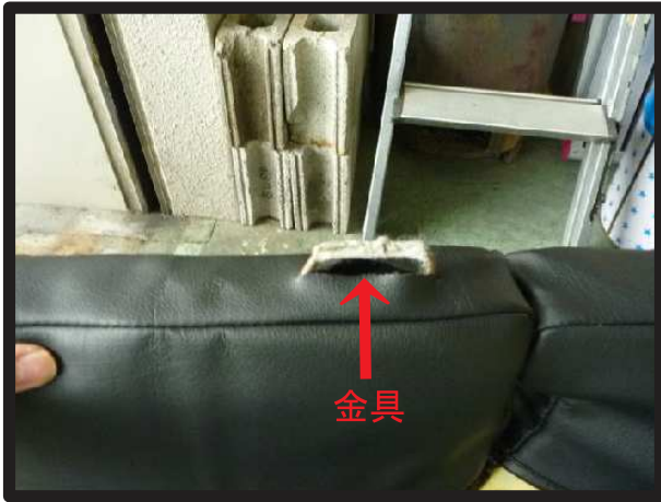
⑦中央には金具がありますのでカバーの加工穴から取り出します。
