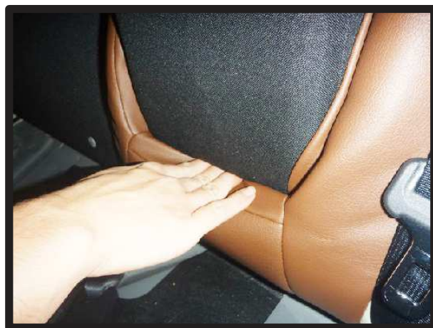
⑱ アームレスト下部の生地をシートとアームレストの隙間に入れ込みます。
