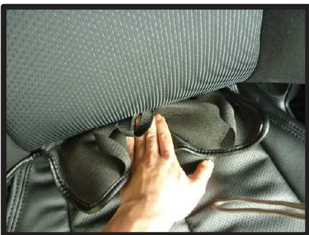
③背もたれと座面の隙間に生地を入れ込みます。背もたれの角度を調整して入れ込みやすい位置で行ってください。
