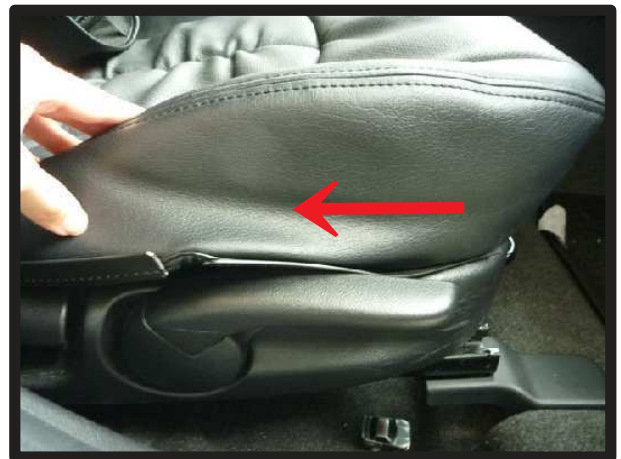
⑥前から後へ順に板状のプラスチックを入れ込んでいきます。内側面も同様に入れ込みます。
