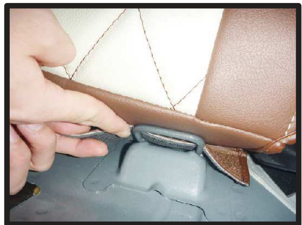
⑫生地はチャイルドシート用アンカーの上側を通します。
