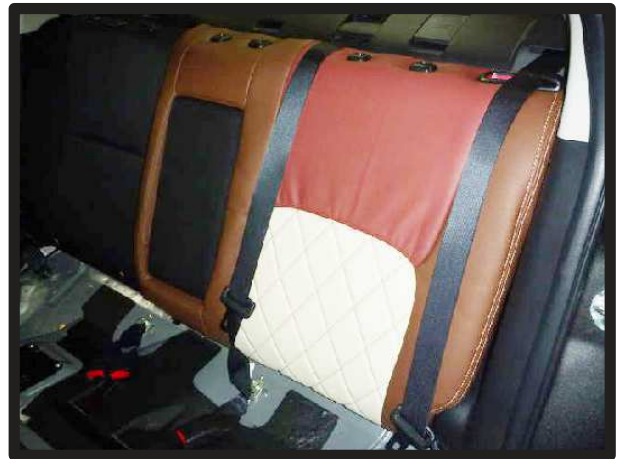
㉒ カバーのラインを整えて2列目助手席側背もたれの完成です。運転席側は一部形状が異なりますが同様に取り付けます。
