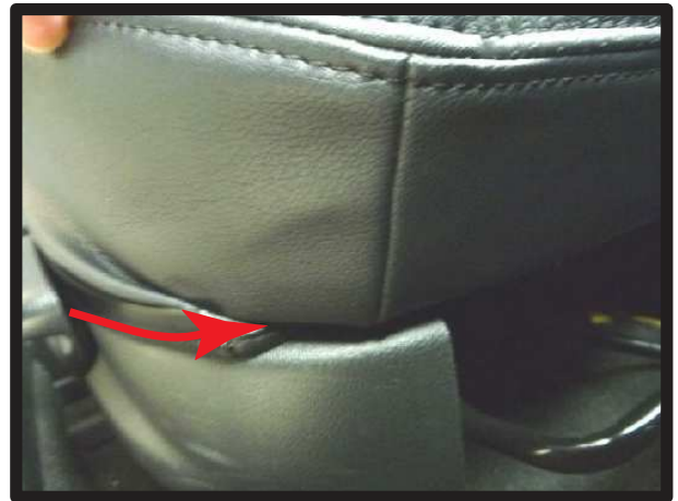
⑤カバー外側面に付いている板状のプラスチックをシートとプラスチック部の隙間に入れ込みます。ヘラ等を使用して、矢印の方向へ入れ込みます。
