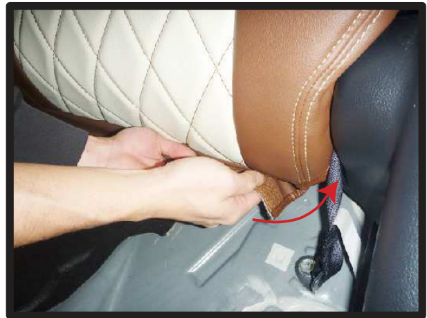
⑪カバーの前側の生地を背面側へまわし込みます。
