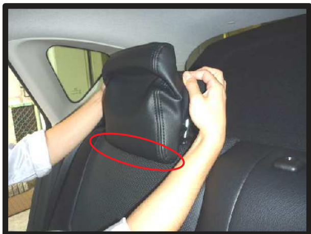
①写真の○部分のヘッドレストの角にカバーの先端を引っ掛けます。
