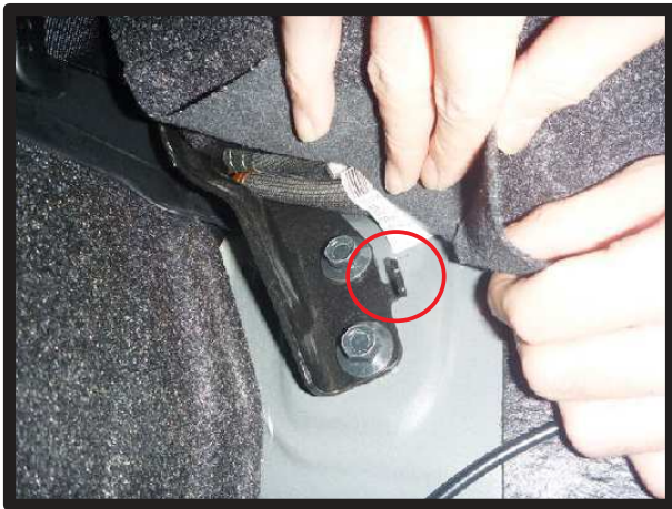
⑧めくり上げた生地の下でシートの生地が○部分の固定具に固定されているので外します。
