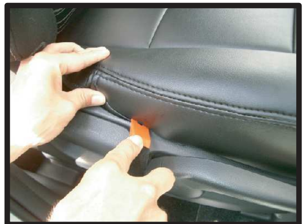
⑥カバー側面の⑤で入れ込んだ後ろの生地を、プラスチックカバーのすき間に入れ込みます。
