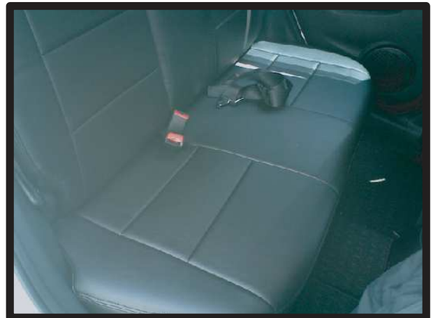
⑭シートは2列目背もたれのカバーを取り付けてから車内に戻して下さい。車内にシートを戻す際も十分注意して作業を行なって下さい。
