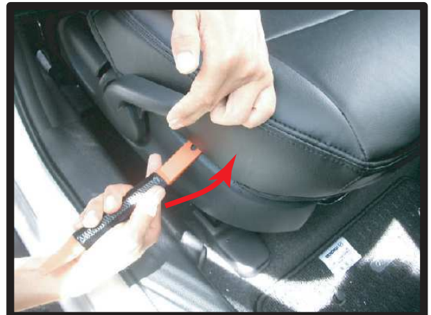
⑤カバー側面の丸く厚みがある部分をシートとプラスチックカバーの隙間に入れ込みます。写真→の方向にヘラ等を使い入れて下さい。
