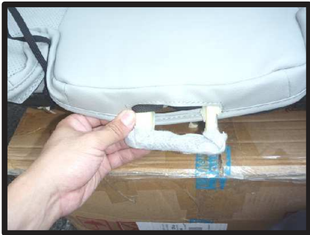
⑦カバーの加工穴からシートの固定具を取り出します。
