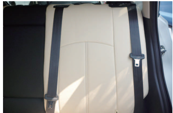
20 カバーのラインを整え、2列目助手席側背もたれの完成です。 運転席側も一部形状が異なりますが、同様に取り付けます。
