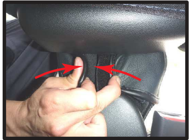
⑦助手席側は、背もたれカバーをかぶせる際に、アームレスト（中央）をかわすようにし、図のように生地同士をマジックテープで固定します。
