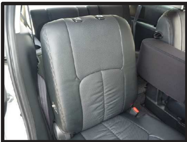
⑥カバーのラインを整え、2列目背もたれの完成です。 助手席側も一部形状が異なりますが同様に取り付けます。
