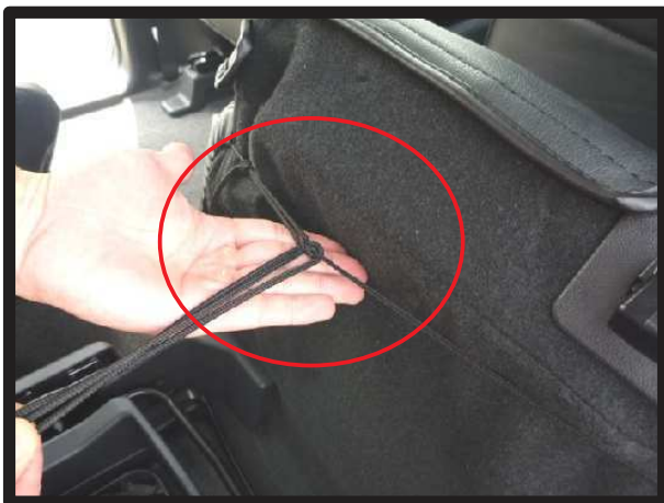
⑥⑤で作った輪に、もう一方のヒモを通し、左右に引き絞り結び留めます。 ※ヒモを強く引っ張りすぎると切れる恐れがありますのでご注意ください。
