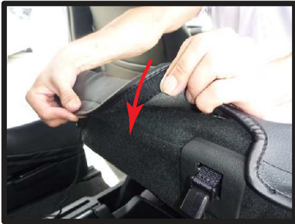
④カバー後方に付いているマジックテープをシートに直接固定します。
