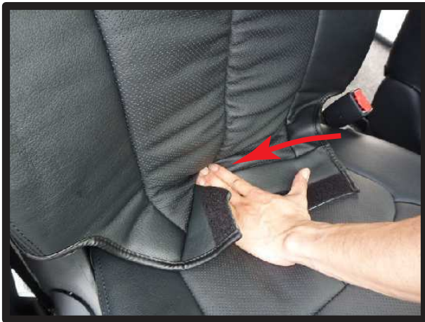
⑧背もたれと座面の隙間に生地を入れ込みます。
