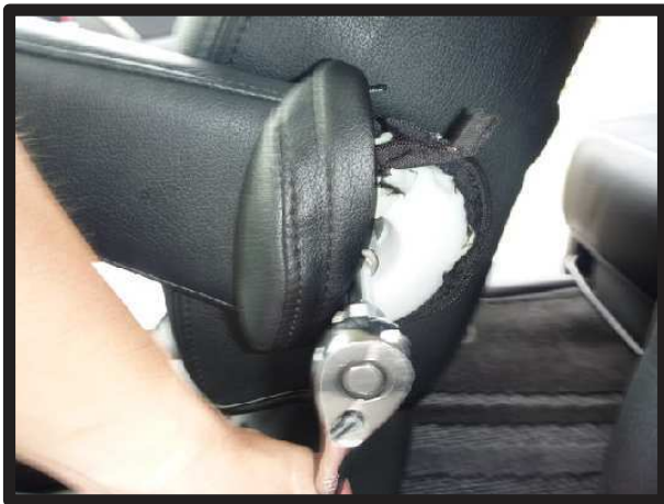
④アームレストを背もたれに取り付け ボルトで固定します。
