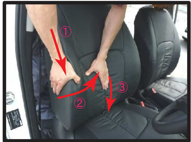
⑪①カバーのラインを整えながら、生地のたるみを無くし、②側面の生地のたるみを中央へ寄せ、③たるみの出た生地を背もたれと座面の隙間に入れ込み、カバーを馴染ませます。
