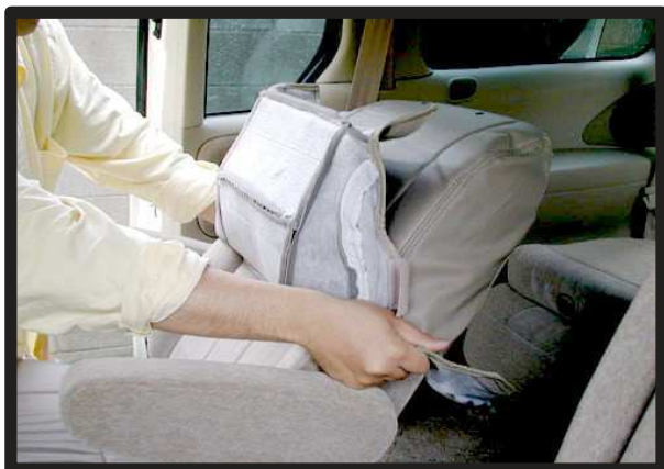
①純正のシートのラインに合わせて背もたれカバーをかぶせます。
