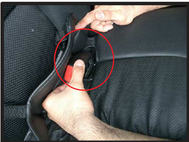
③シートベルトの受け口を、カバーの穴から抜き出しておきます。
