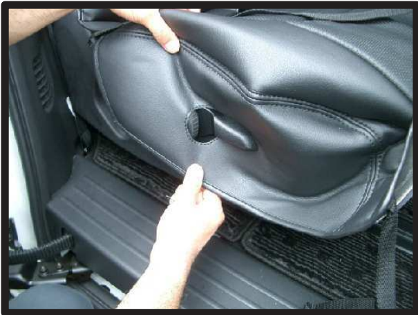
①側面のシートリフター部分を、カバー側面の穴に通していきます。
