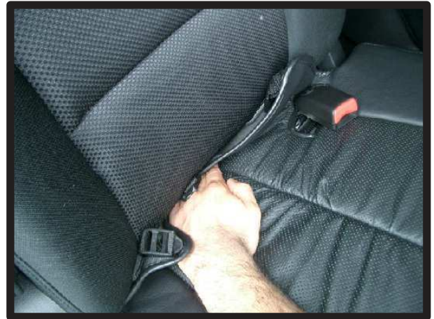
④バックルの付いた部分を座面と背もたれの間に入れ込みます。
