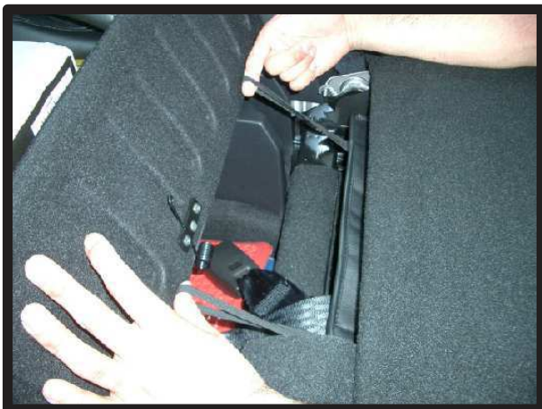
⑥④で入れ込んだ部分を、背面側に引き出し、ゴムを座面裏の適当な個所に固定してください。 作業は、背もたれの角度を調整しながら、座面前側から手を伸ばして作業を行うと簡単にゴムに手が届きます。
