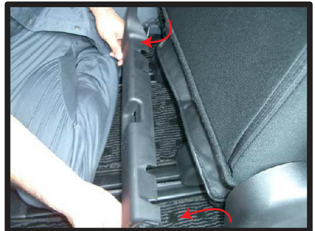
⑤背面側に回りこんで、座面裏のプラスチックのカバーを取り外します。座面横のプラスチックの部分に、軽く引っかかっています。
