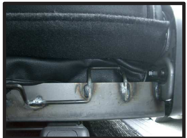
⑥④で引き出した部分を、シートのクッション部分と金属部分の隙間に、入れ込んで下側に引き出します。 ※金属部分で怪我をする恐れがありますので、気を付けて作業を行ってください。
