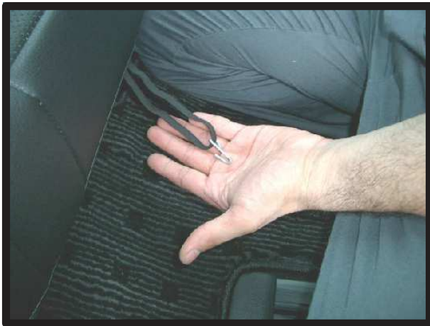
⑤前と側面にあるゴムは、直接シート裏にある金属部分に引っ掛けます。一部届きにくい箇所には、ゴムにS字フックを取り付けて、座面裏側の適当な箇所に引っ掛けます。
