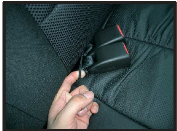
⑧取り外しておいたシートベルトの受け口を、カバーにあるループ状の箇所に通してください。
