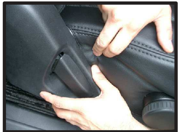
⑪側面をプラスチックのカバー部分に挟み込みます。
