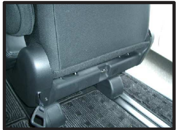
⑩⑤で取り外したプラスチックのカバーを元に戻します。
