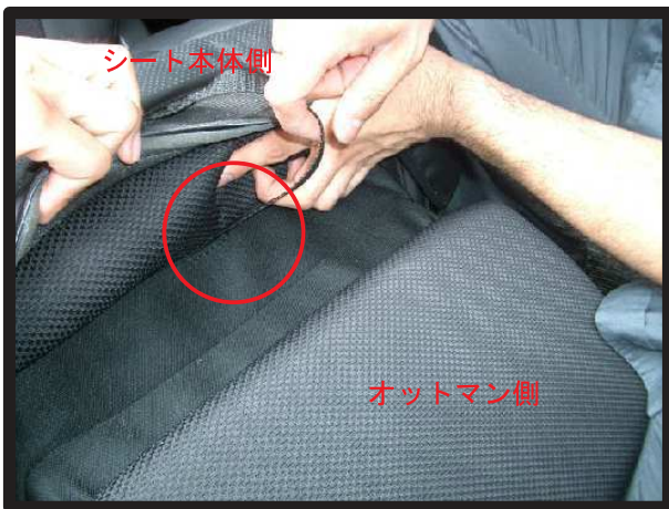
⑧オットマンとシート本体の隙間に、2～3 cm程度の切れ込みが開いています。フロントの3本あるベルトの内、真中のベルトを通して座面後ろへと抜き出し背面のバックルと固定します。両サイドの2本も裏面を通して、バックルと固定します。
