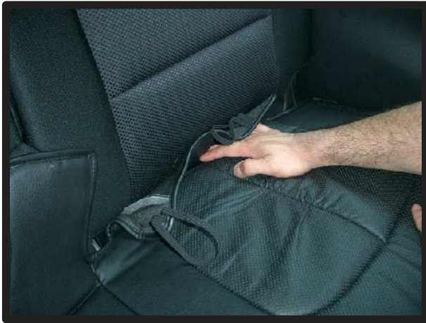
④座面と背もたれの隙間に、カバーを入れ込んでおきます。
