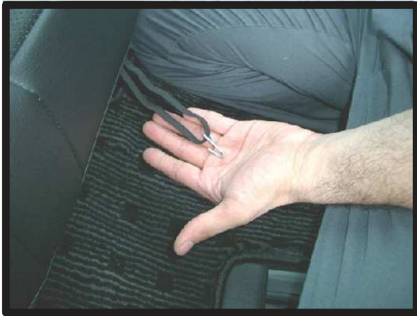
⑤前と側面にあるゴムに、S字フックを取り付けて、座面裏側の適当な個所にフックを引っ掛けて、固定します。
