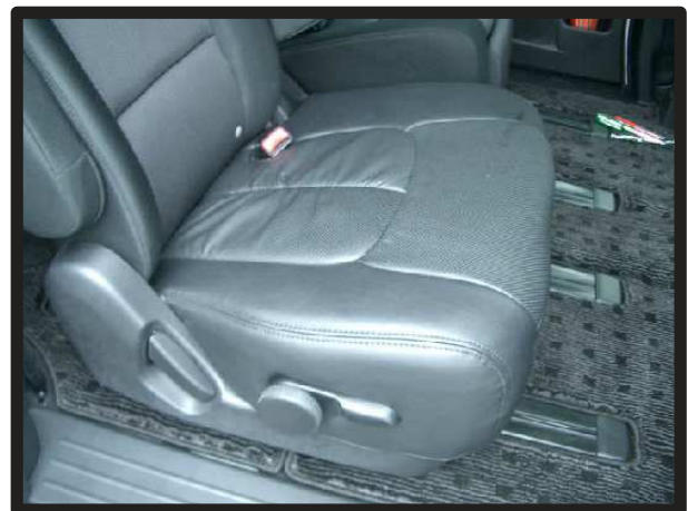
⑫カバーをシートに馴染ませるように調整して、座面の完成です。助手席側も同様にして取付を行ってください。
