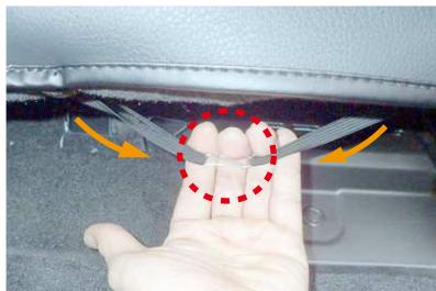
10 シートの裏側から引き出したゴム同士を共に寄せ合い、付属の金属フックでつなぐように固定します。
