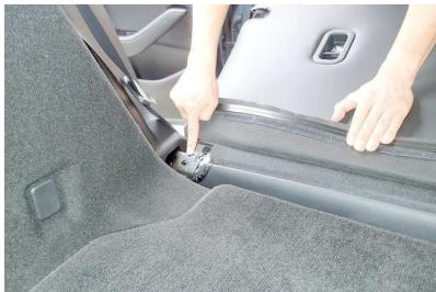
52 背もたれを車体に固定していきます。背もたれのボルト穴の位置と車体側の固定用金具の位置を合わせます。固定用金具は両端にあります。左右共に合わせて下さい。
