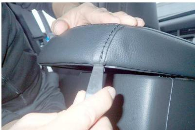
7 コンソールの後ろ側の図の生地の縫い目部分は、生地を入れ込むのが一番ぎっくなっています。生地に傷を付けないように、慎重に作業を行って下さい。
