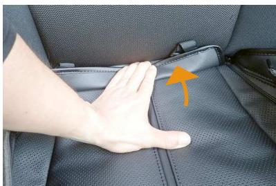
3 背もたれと座面の隙間に生地を入れ込みます。背もたれの角度を調整して、生地が入り込みやすい位置で作業を行って下さい。
