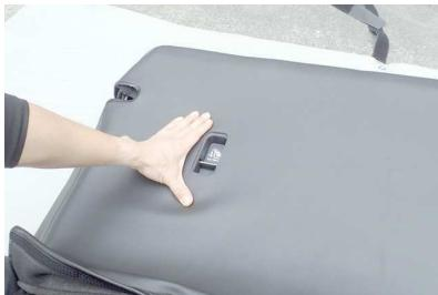
16 シート背面のチャイルドシート固定用フックの位置とカバーの加工穴の位置が合っているかを確認します。すれている場合はカバーの装着がずれてしまっているので、再度調整して下さい。
