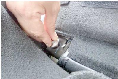
51 2列目座面の車体へ戻す作業の完成です。背もたれを戻す際にカバーがずれてくる可能性があります。背もたれを車体に戻してから、カバーのラインを調整しなおして下さい。
