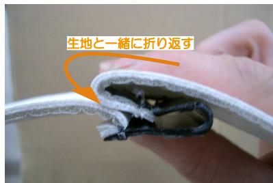
5 プラフックの固定方法は、フック状のプラフックに板状のプラフックを生地と一緒に折り返して、はめ込み固定します。
